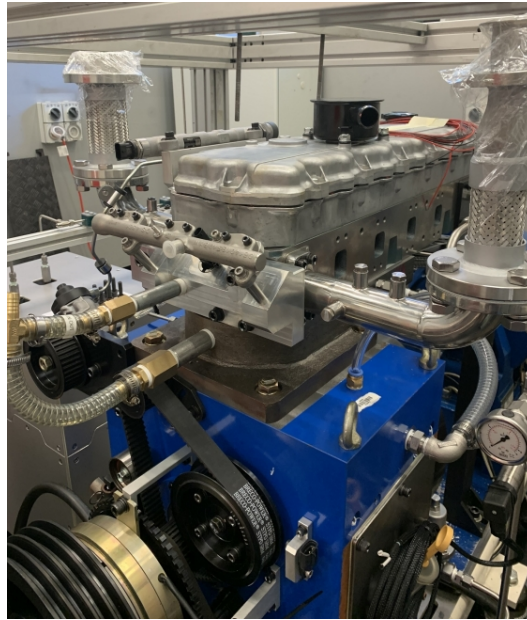
Figura 3.3: Motor de combustión interna alternativo adaptado con un sistema de inyección dual de hidrógeno y diésel desarrollado en la universidad de UNSW
