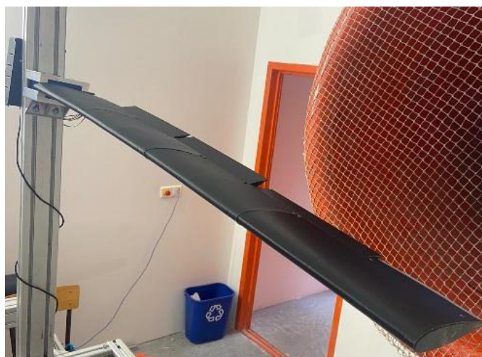
figura 10: Maqueta instalada en el túnel de viento.
