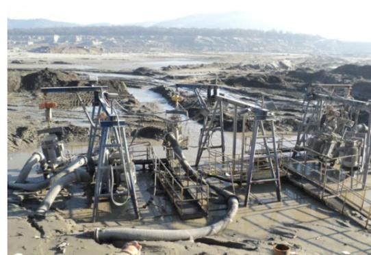
Figura 1.5, Sumidero, sector impulsión hacia planta de proceso.
