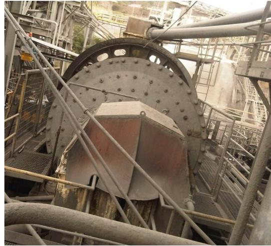
**Figura 1.11, Molino de Remolienda MVC**
