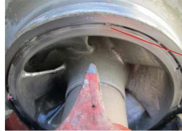
**Figura 1.44 Excesiva holgura por desgaste en anillos sellos de cámara succión contra descarga.**
