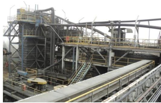
Figura 1.15, Columnas de flotación, 2da a 4ta limpieza
