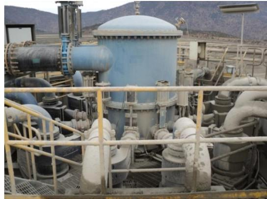
Figura 1.7, Batería de clasificación Colihues
