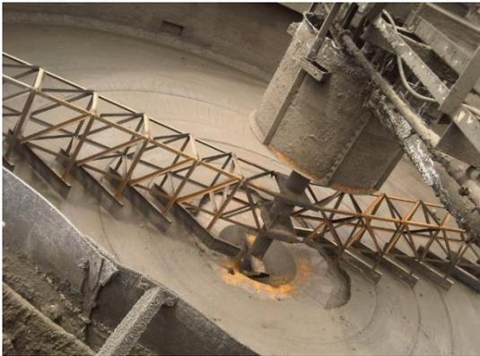
Figura 1.16, Espesador mixto, acumulador planta flotación selectiva
