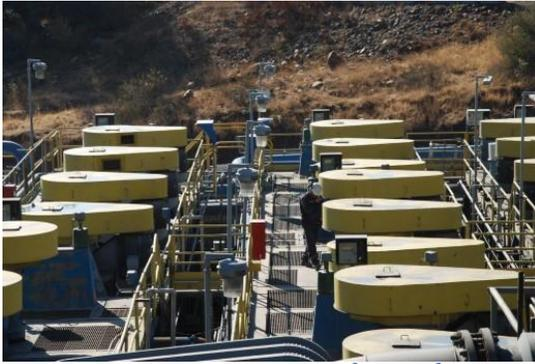
Figura 1.14, Celdas OK38 1500 ft<sup>3</sup>(42,5 m<sup>3</sup>), bancos 1ra limpieza
