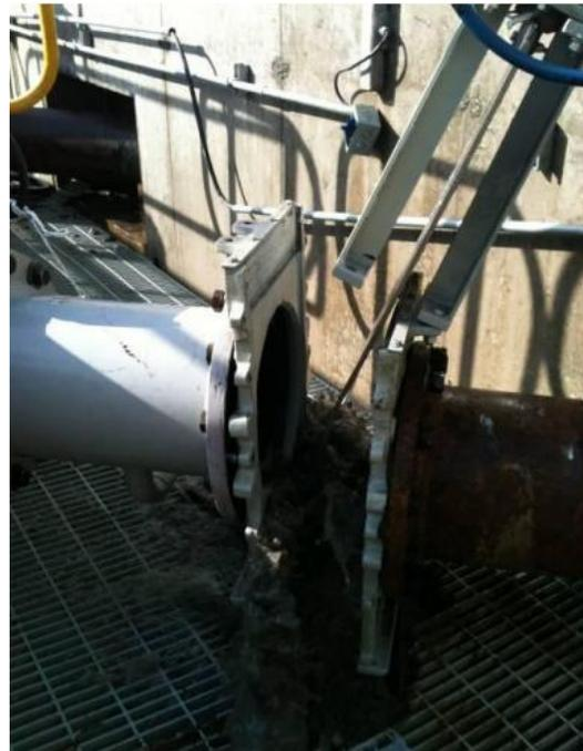
Figura 2.2, Colapso de válvula guillotina línea de descarga bomba RABI 1
