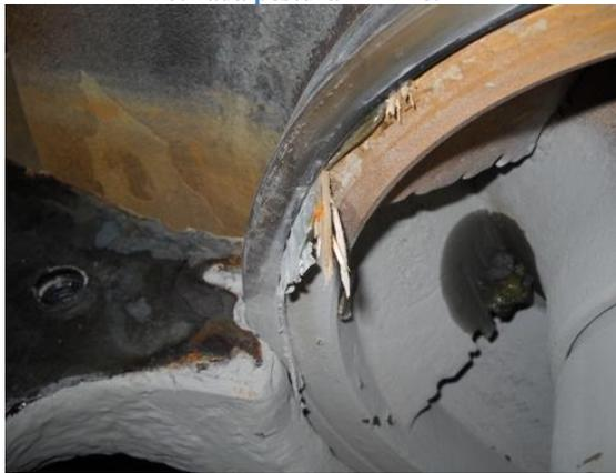
Detalle de residuos presentes entre anillos de desgaste bomba retirada postura RABI 8.
