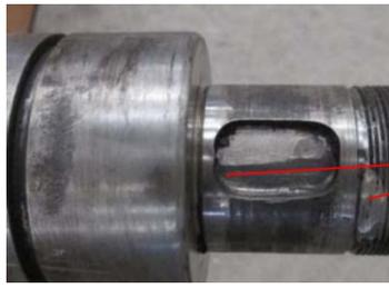
**Figura 1.43 Desgarro en chavetero de afianzamiento pistón-eje.**
