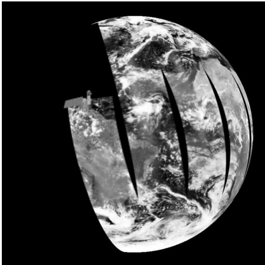
Ilustración 3: Sistema de escaneo del sensor Modis. Fuente: Http://sos.noaa.gov/images/atmosphere/aqua_swath.jpg
