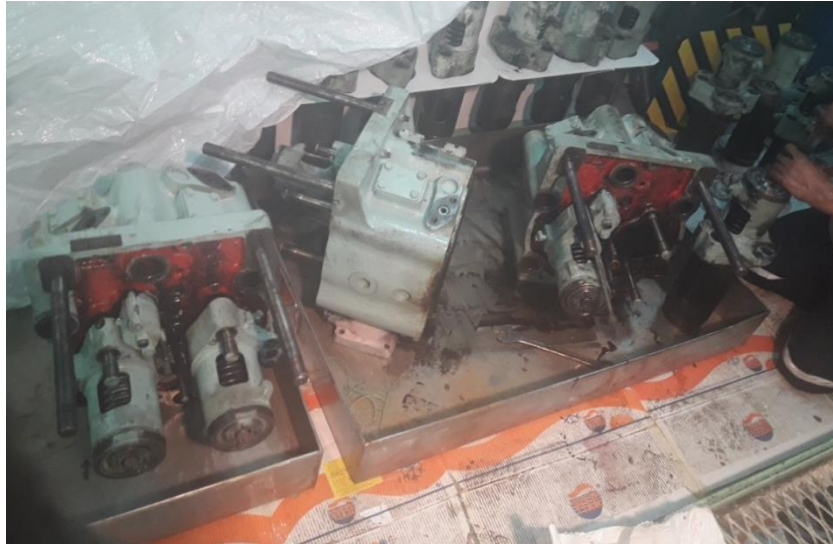
Ilustración 3-5. Área de trabajo y limpieza de culatas y válvulas
