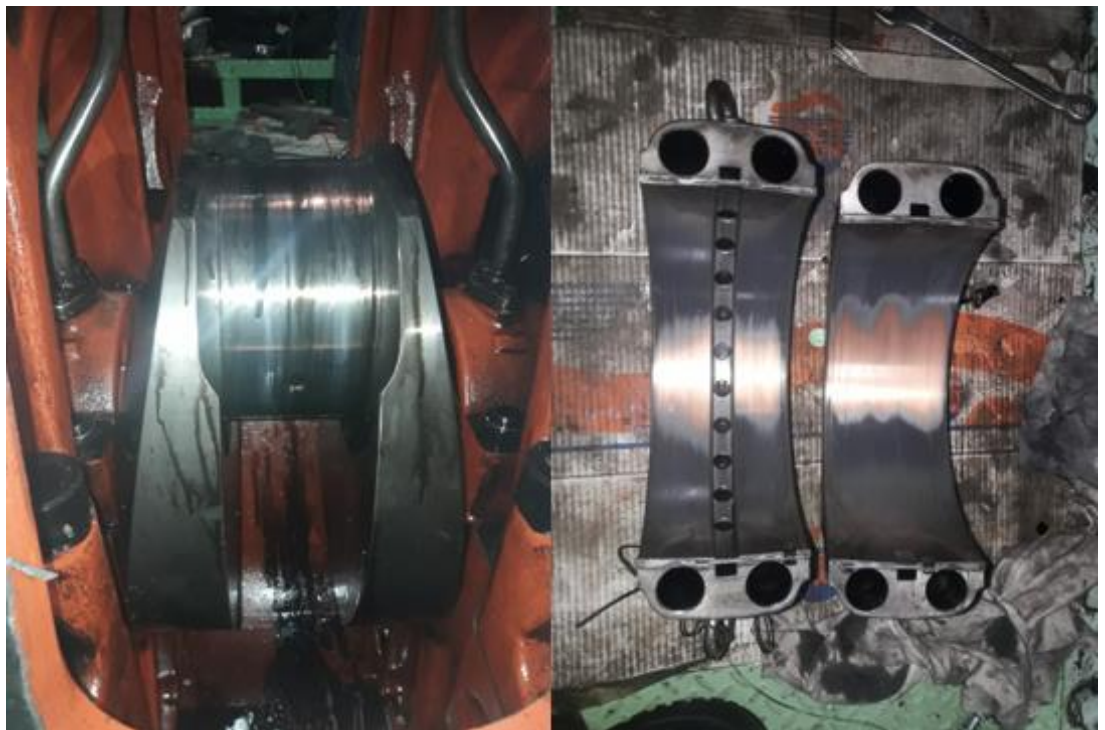
Ilustración 1-7: Puño cigüeñal y respectivos metales de biela
