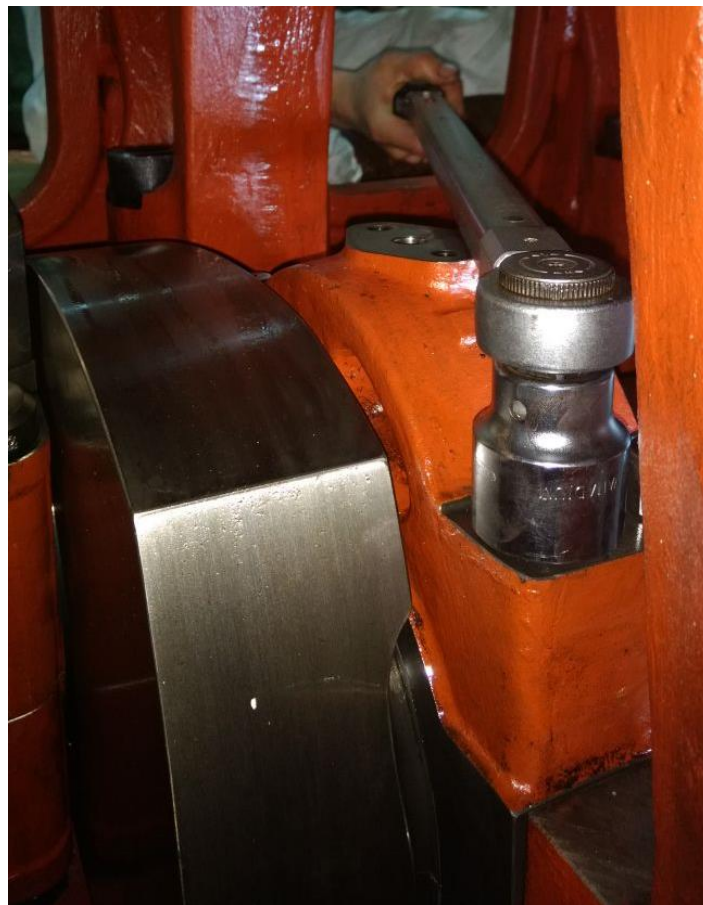
Ilustración 3-16. Desmontaje tuercas de cojinete de biela
