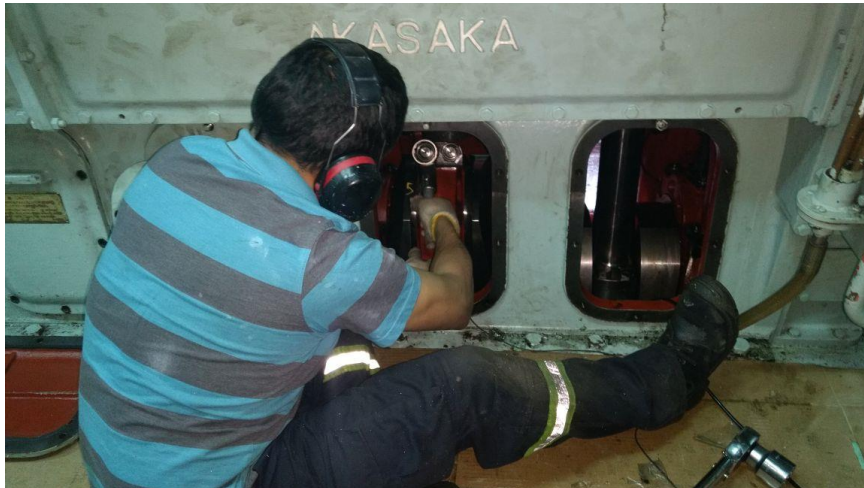
Ilustración 2-29: Postura realizada para el servicio de bielas motor principal akasaka
