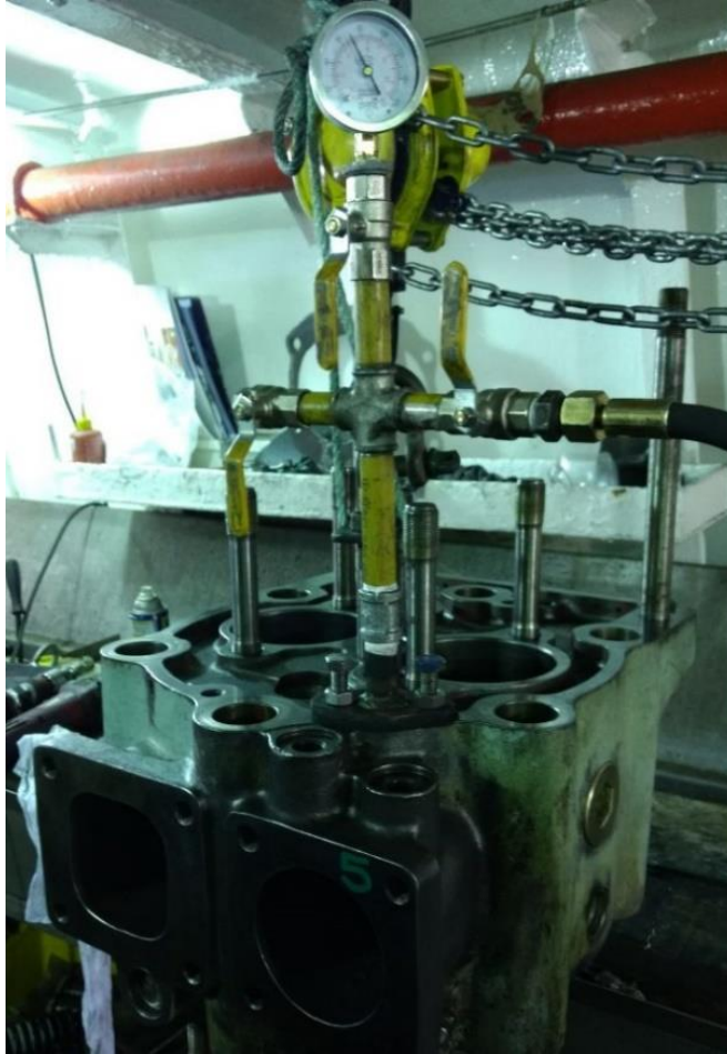
Ilustración 1-9: Culata motor principal en proceso de prueba hidrostática
