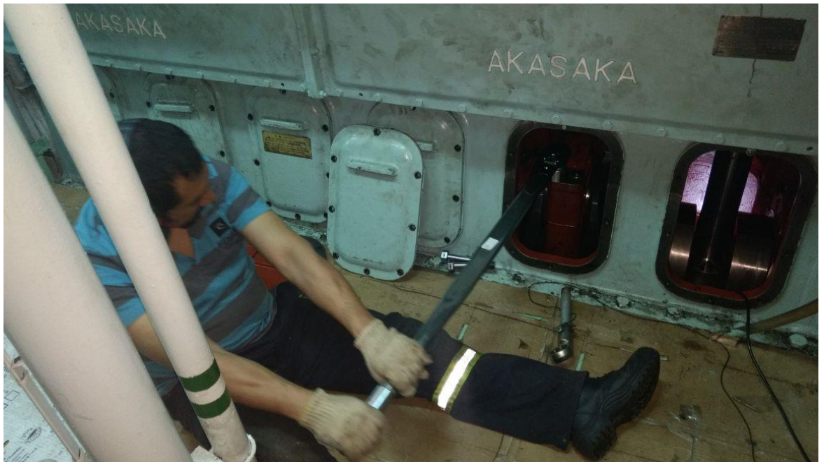
Ilustración 3-38: apriete cojinetes de biela
