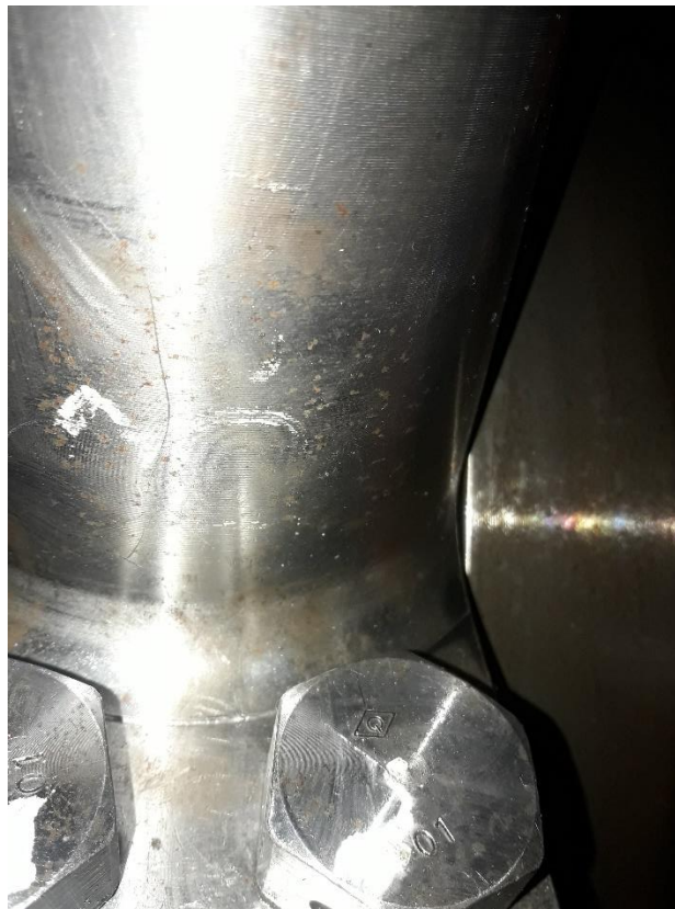
Ilustración 3-34: rayadura presente en cigüeñal motor AKASAKA
