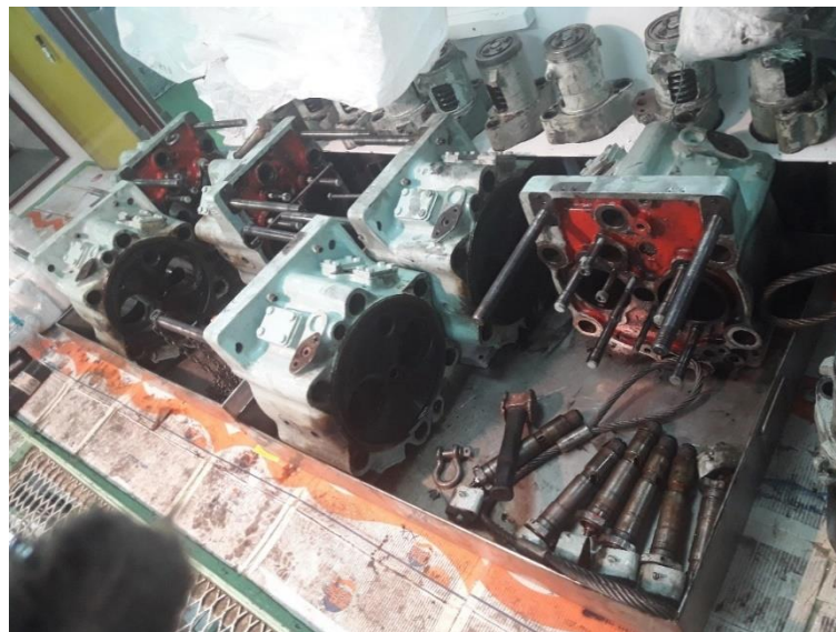
Ilustración 3-6. Culatas en proceso de limpieza y recorrido
