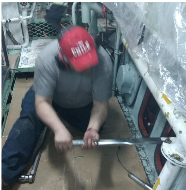
Ilustración 1-10: jefe de máquinas apoyando en actividad de torque de pernos de biela
