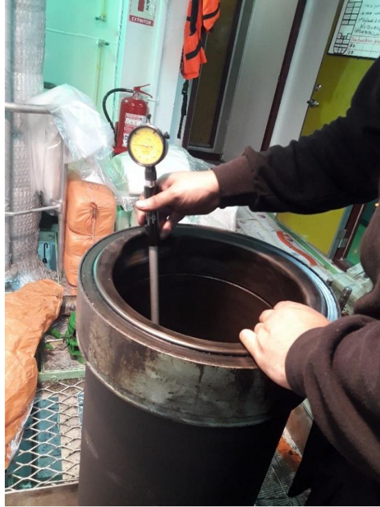
Ilustración 1-8: Trabajo de calibración de camisas motor principal
