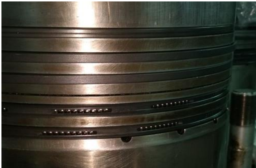
Ilustración 3-13. Pistón limpio con anillos nuevos
