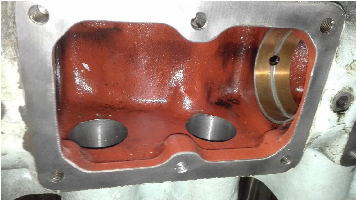
Ilustración 2-15: Descanso de eje de levas con su respectivo buje y orificio de lubricación
