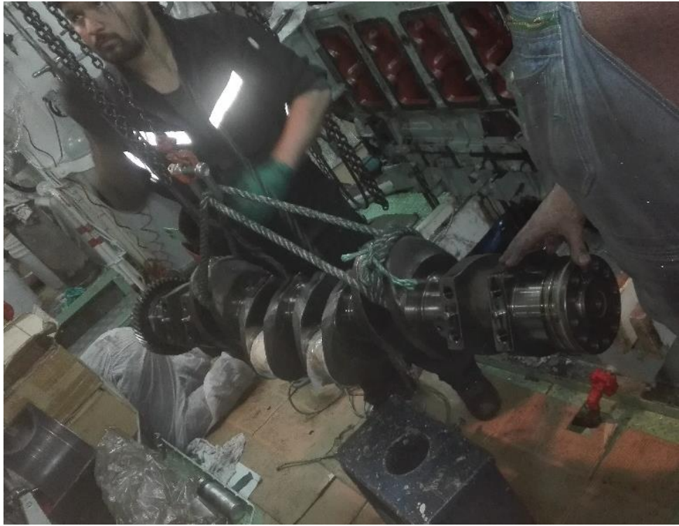
Ilustración 2-23: Cigüeñal motor generador yanmar
