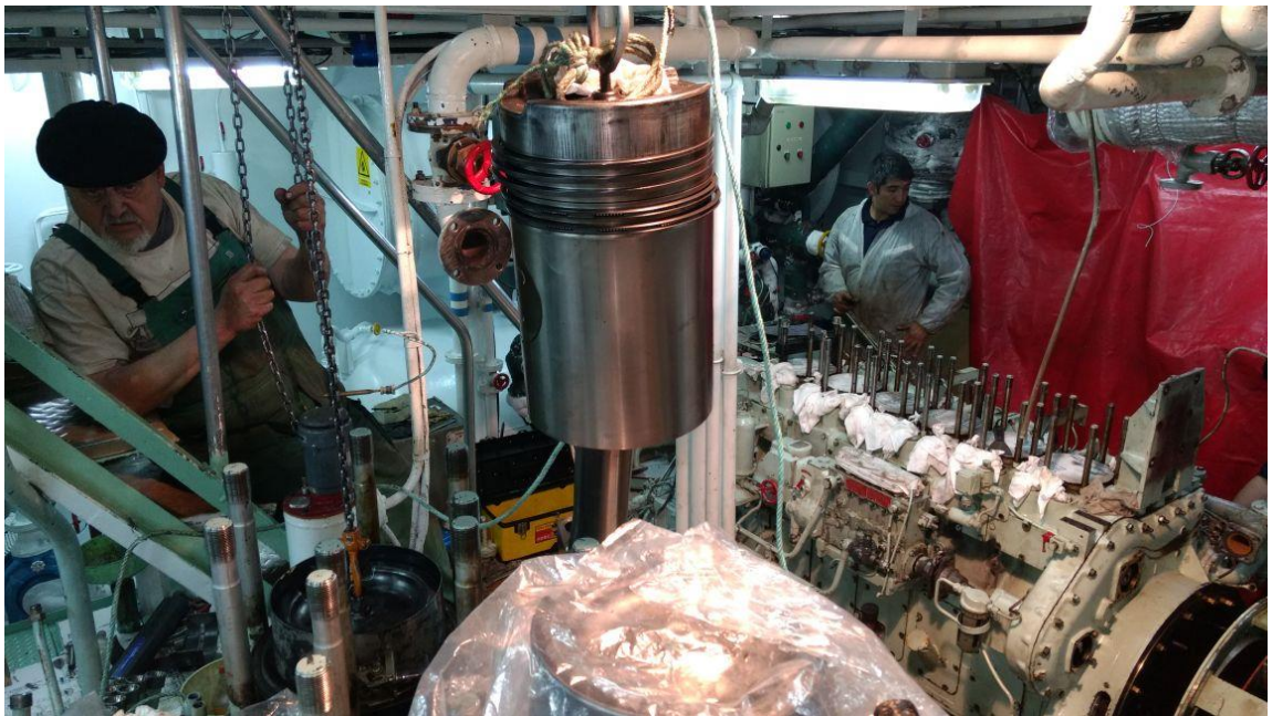
Ilustración 3-37: montaje pistón recorrido motor akasaka
