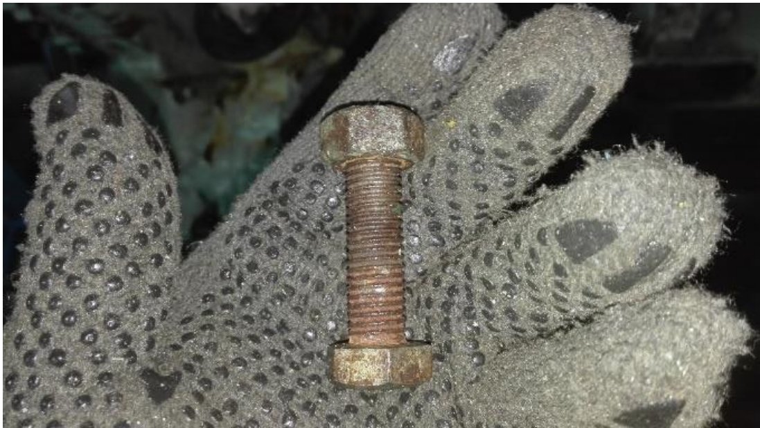
Ilustración 1-3: Estado promedio de pernos del motor principal
