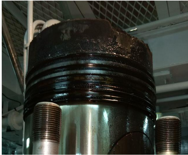
Ilustración 3-12. Pistón y anillos antes de proceso de limpieza
