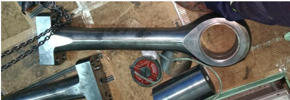
Ilustración 2-18: Biela sin embolo ni cojinetes
