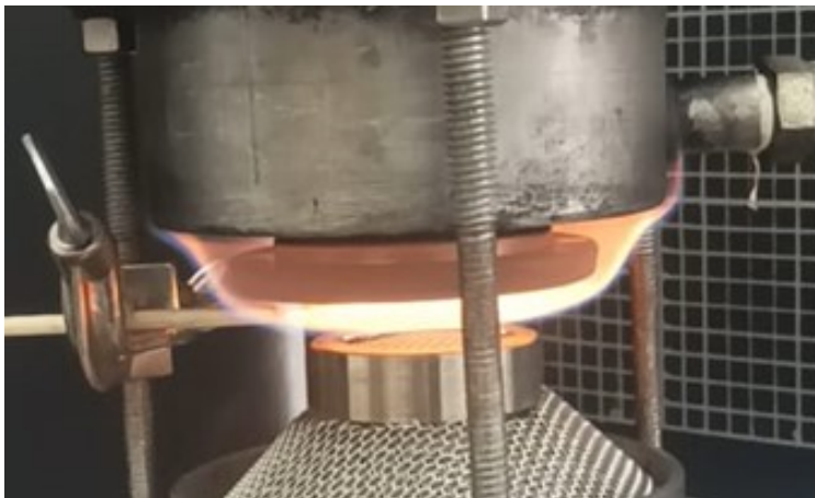
Figura 30: Quemador operando sin cortina de nitrógeno.
