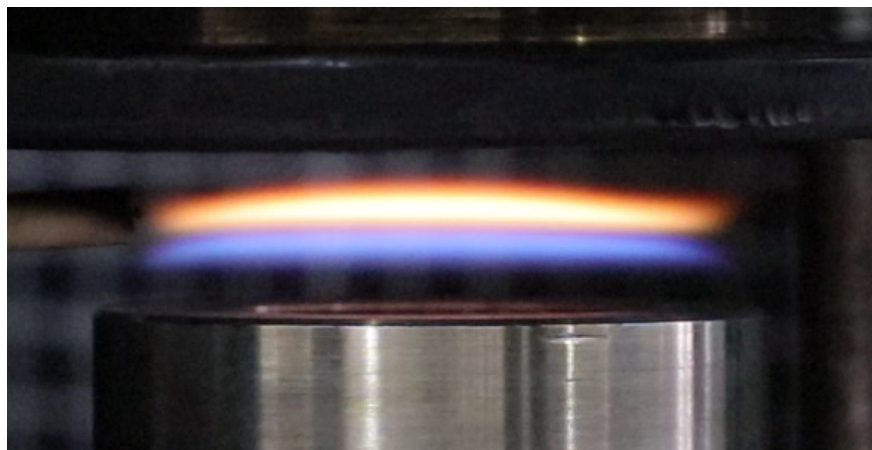
Figura 37: Llama D. 70 % metano y 30 % hidrógeno.
