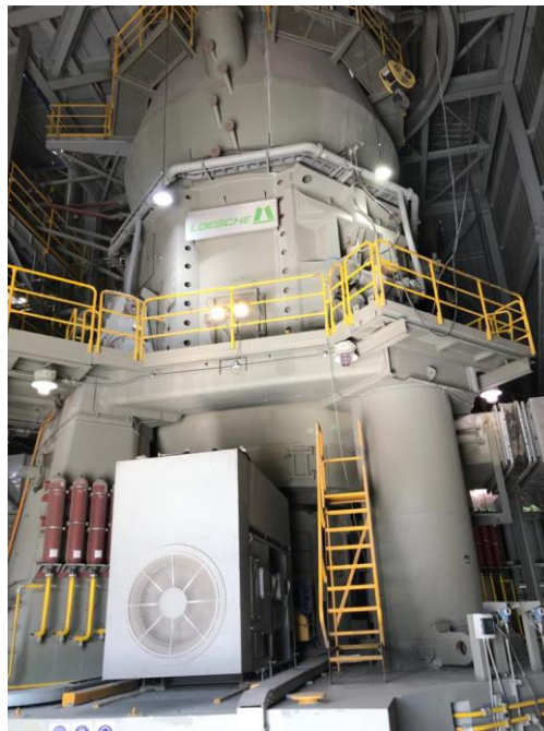
Figura 1-4 Molino vertical de rodillo LOESCHE
