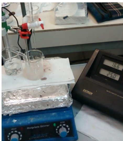
Figura 26. Sistema medición de cloruro.
