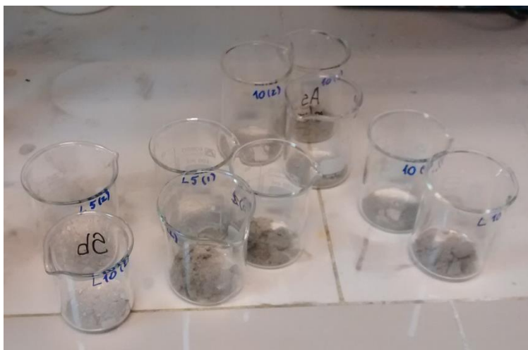
Figura 24. Vaso de precipitado con ripios que serán sometidos a digestión en agua regia.
