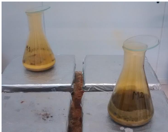
Figura 16. Proceso de digestión con agua regia para determinación de plata total.
