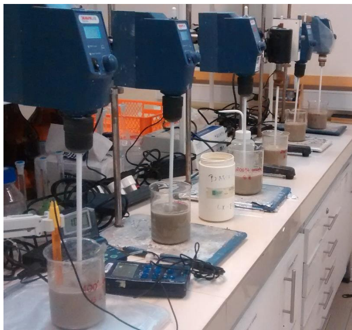
Figura 22. Lixiviación agitada a 400 RPM.
