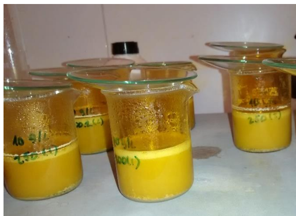
Figura 25. Proceso de digestión mediante agua regia.
