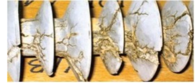
(c) Tracking y erosión en aislador compuesto [16].
