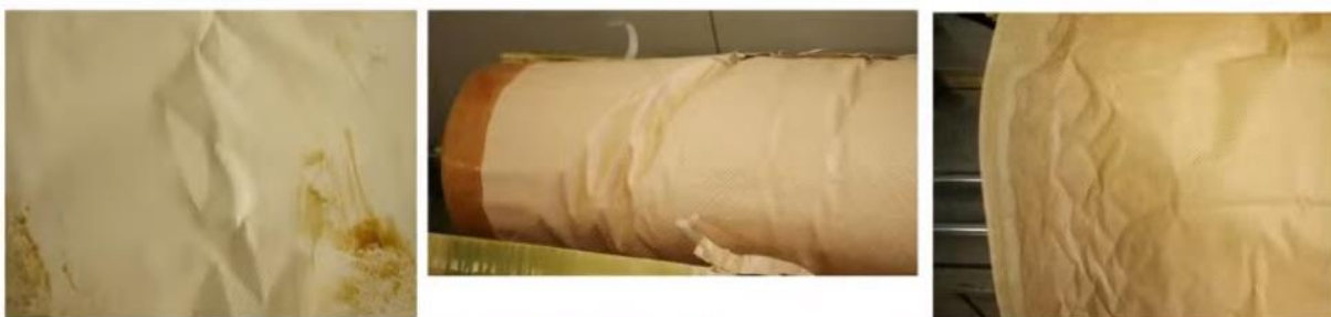
Figura 22: Arrugas y pliegues en una membrana de OI. Fuente: Pisano, F. y Grupo Pentalia (2022).
