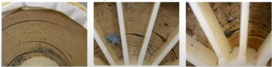
Figura 21: Partículas y depósitos en una membrana de OI. Fuente: Pisano, F. y Grupo Pentalia (2022).
