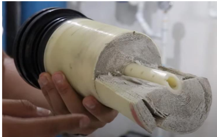
Figura 27: Corte de una membrana desechada de ósmosis inversa de 4x40 pulgadas. Fuente: Oasis Exprés, 2023.
