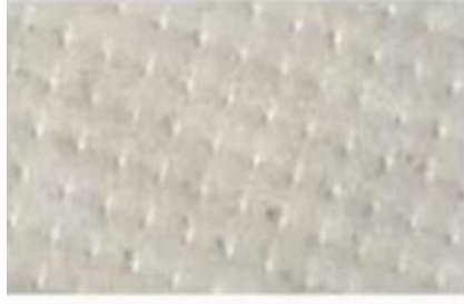
Figura 23: Vista microscópica del daño en la superficie de una membrana de OI provocado por el material espaciador. Fuente: Pisano, F. y Grupo Pentalia (2022).
