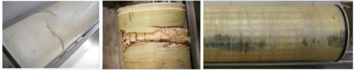
Figura 18: Daños en la carcasa de una membrana de OI. Fuente: Pisano, F. y Grupo Pentalia (2022).
