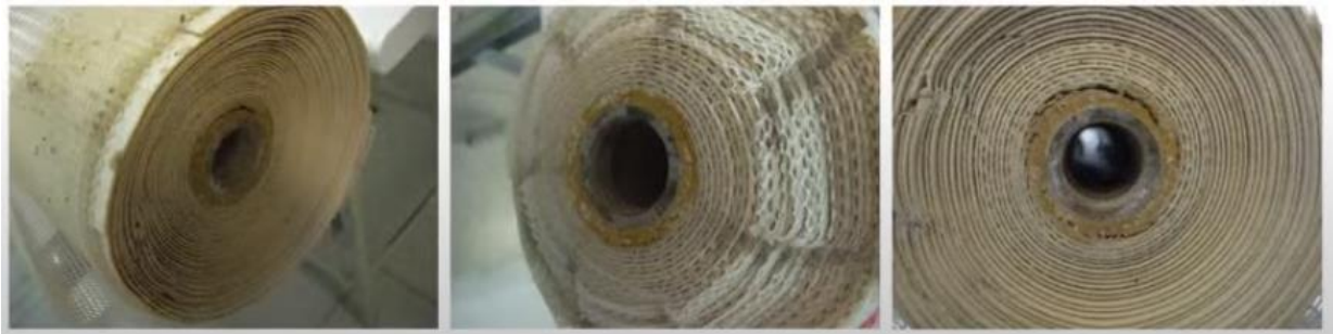
Figura 19: Efecto telescopio en una membrana de OI. Fuente: Pisano, F. y Grupo Pentalia (2022).
