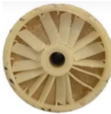
Figura 16: Tapa antitelescopio dañada. Fuente: Pisano, F. y Grupo Pentalia (2022).
