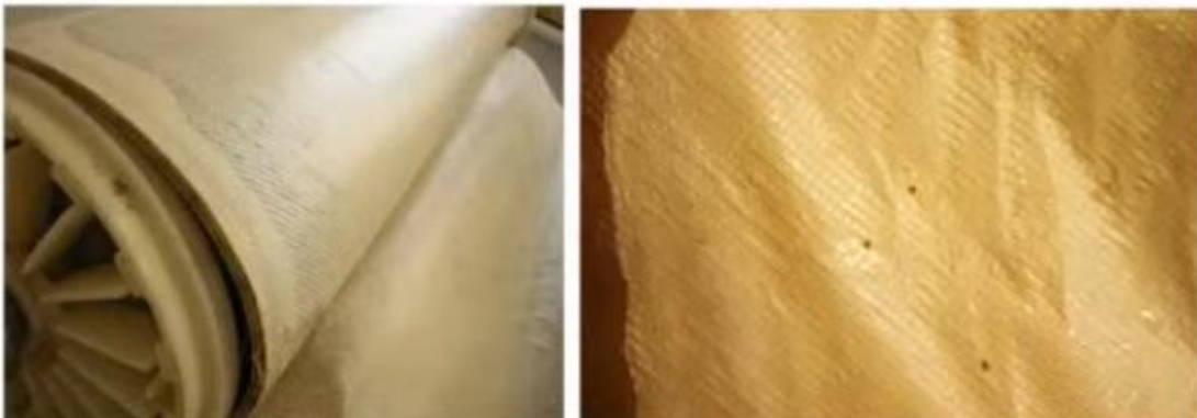
Figura 24: Delaminación de capa de poliamida de una membrana de OI. Fuente: Pisano, F. y Grupo Pentalia (2022).
