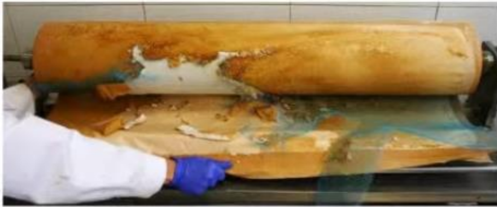
Figura 25: Incrustación en una membrana de OI. Fuente: Pisano, F. y Grupo Pentalia. (2022).
