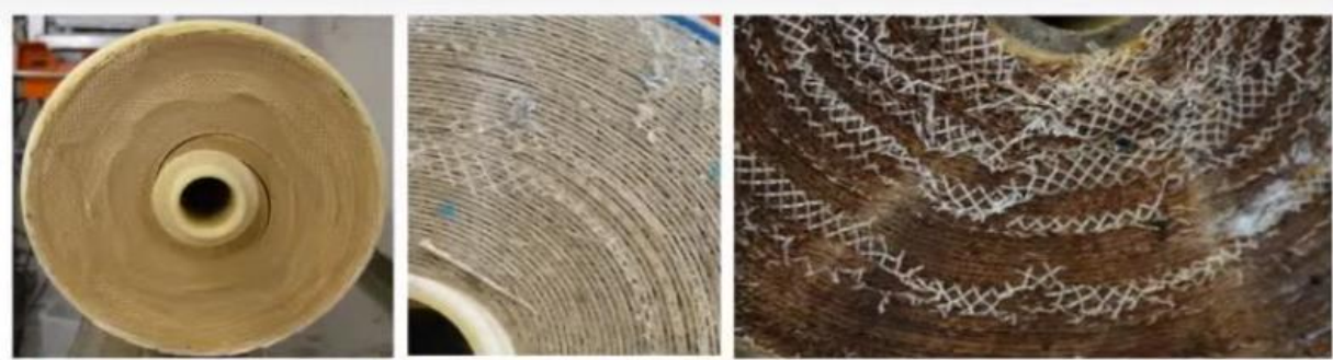
Figura 20: Desplazamiento del material espaciador en una membrana de OI. Fuente: Pisano, F. y Grupo Pentalia (2022).
