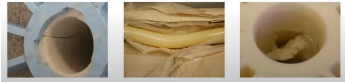
Figura 17: Daños en el tubo de permeado de OI. Fuente: Pisano, F. y Grupo Pentalia (2022).
