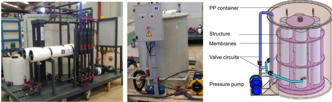
Figura 35: Reactor de reciclado a escala piloto, sistema activo (izquierda), sistema pasivo (centro) y diseño del sistema pasivo(derecha) que contiene 6 membranas en espiral en la estructura. Fuente: Valoriza Agua, s.f.
