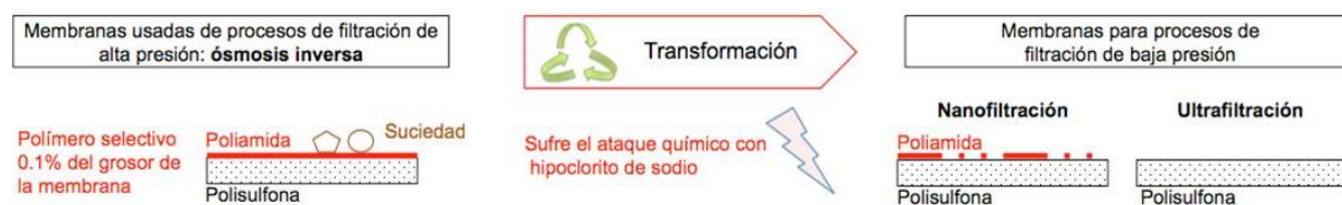
Figura 14: Esquema conceptual del proceso de transformación de las membranas de OI en membranas de NF y UF. Fuente: REMTAVARES, 2015.
