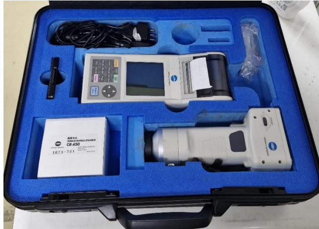
Figura 16: Colorímetro Konica Minolta modelo CR-400, usado en este estudio.
