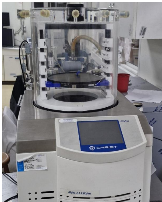
Figura 12: Liofilizador Christ, modelo Alpha 2-4 LSCplus, usado en este estudio.
