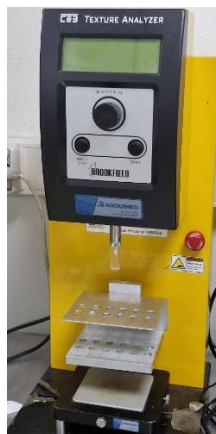
Figura 18: Texturómetro TexturePro CT V1.2 Build 9, usado en este estudio.
