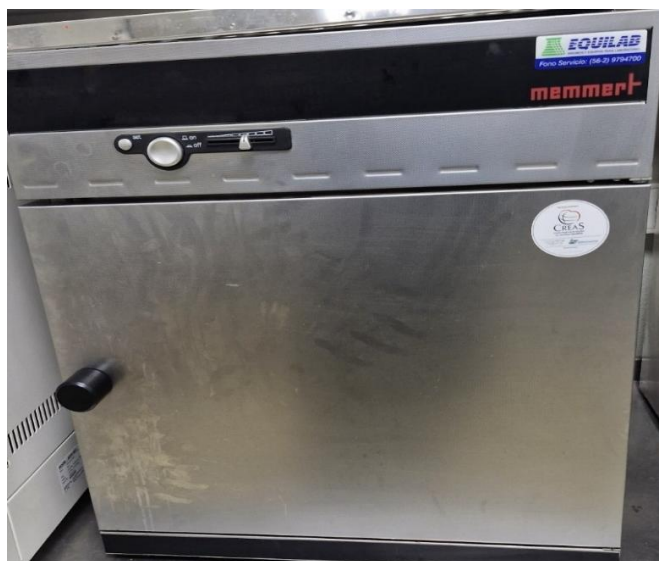
Figura 15: Estufa de laboratorio Memmert UM200, usada en este estudio.
