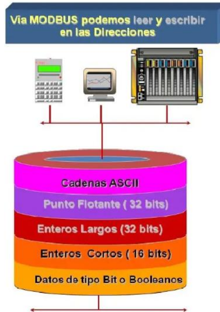
Figura 2-19 Estructura de registros modbus del OMNI.
