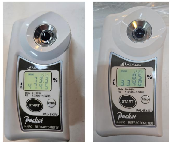
Figura 6-1. Índices de refracción de glicerina pura (izquierda) y de agua destilada (derecha).
