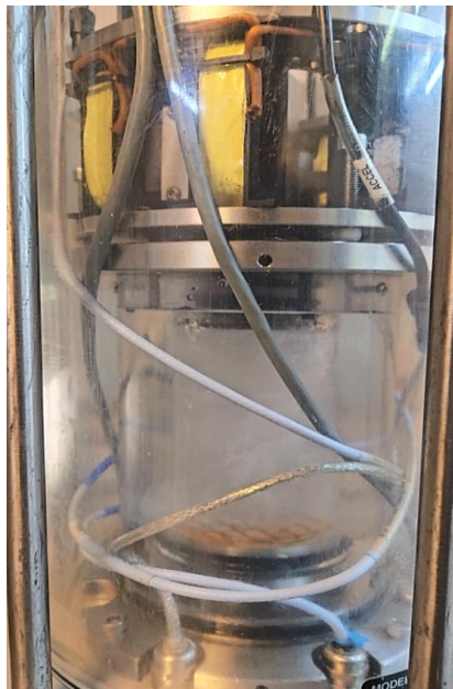
Figura 6-9. Probeta de cuarzo fundido en equipo de RC y TS.
