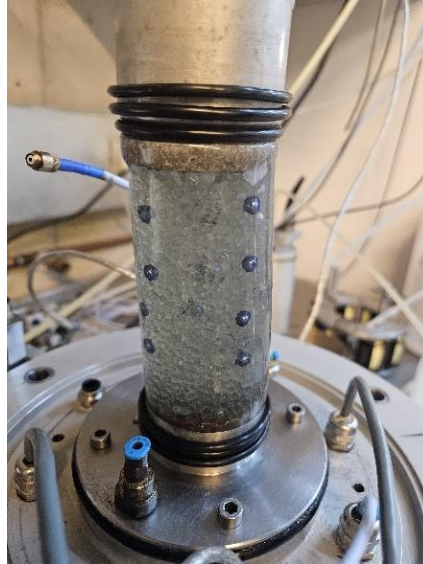
Figura 6-6. Probeta de SST en base a esferas de vidrio de borosilicato.
