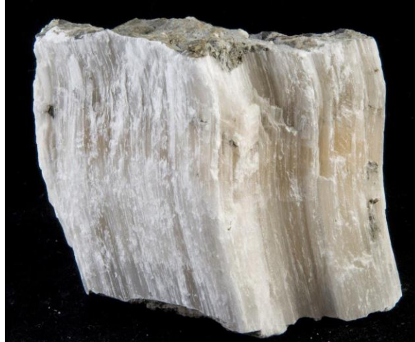
Ilustración 4 : Exfoliación en roca de Yeso
