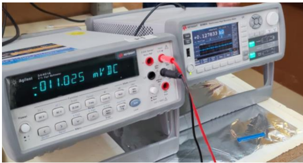
Figura 8: imagen de voltímetro a la izquierda y el femtoamperímetro a la derecha.
