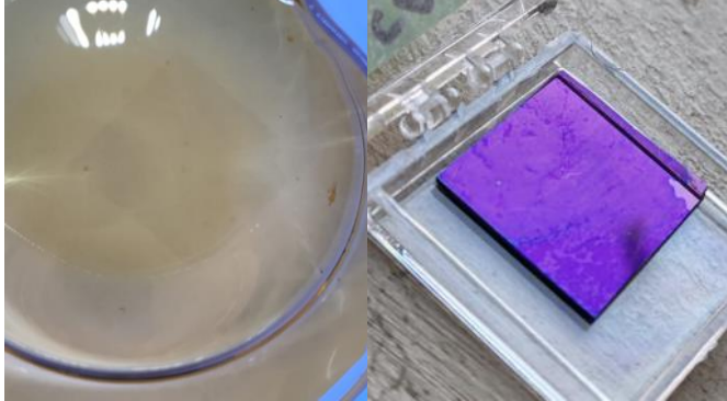
Figura 14. Grafeno flotando sobre solución de nitrato ferrico a la izquierda y muestra del mismo grafeno transferido sobre oblea de silicio a la derecha. Grafeno GrPC02.
