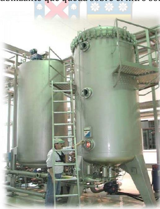
**Figura 13.** Filtro de PVPP. Fuente: Planta de elaboración CCU Temuco, 2018
