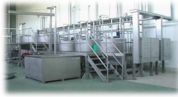
**Figura 18.** Estación de mezcla de tierras y preparación de aditivos. Fuente: Planta de elaboración CCU Temuco, 2018
