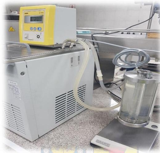
**Figura 29.** Equipo Viscosímetro de bola Stokes. Fuente: laboratorio físico químico
