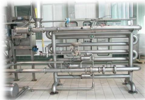
**Figura 19.** Planta de carbonatación de cerveza. Fuente: Planta de elaboración CCU Temuco, 2018
