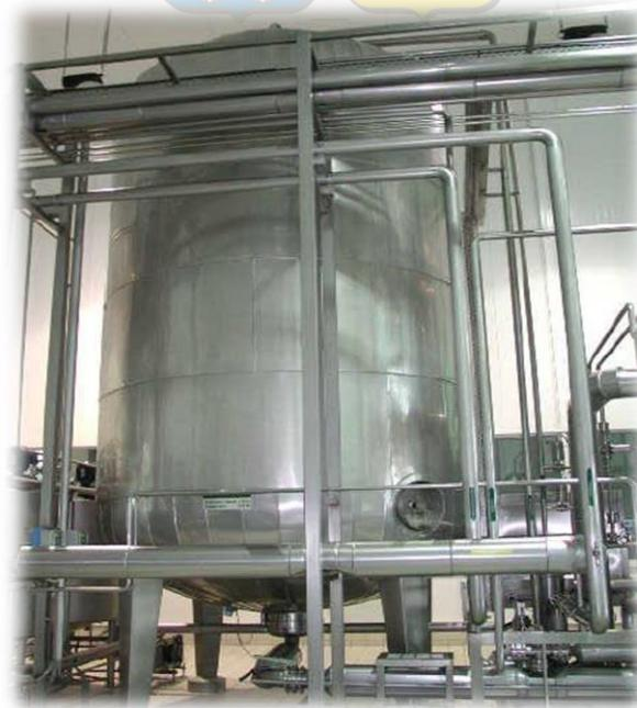
**Figura 17.** Tanque de cabeza y cola. Fuente: Planta de elaboración CCU Temuco, 2018
