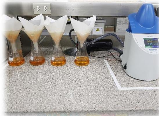
**Figura 32.** A la izquierda: muestras de cerveza filtradas para analizar turbidez. A la derecha: equipo Turbidímetro nefelométrico. Fuente: laboratorio físico químico CCU
