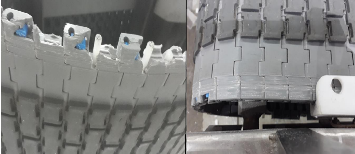
Figura 33: Desgaste en laterales de banda.
