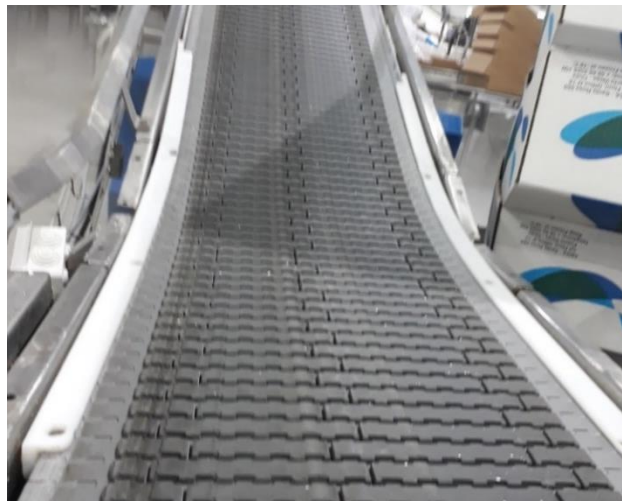
Figura 32: Equipo con guías de sujeción laterales en sección inclinada.
