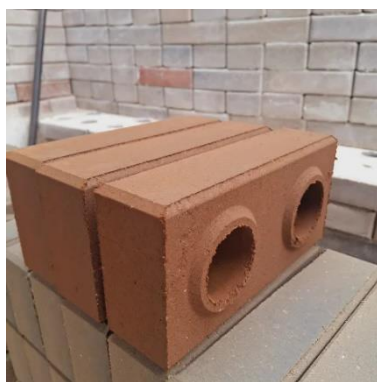
Figura 3-1 Ladrillos ecológicos con relaves mineros
