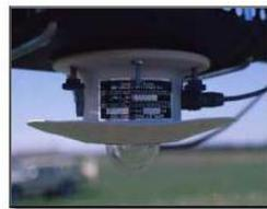
**Figura 1.2:** PIRANÓMETRO RADIACIÓN SOLAR REFLEJADA.-
