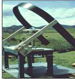
**Figura 1.3:** PIRANÓMETRO RADIACIÓN SOLAR DIFUSA.-
