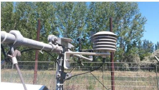
Foto 3: Sensor Temperatura y Humedad.-
