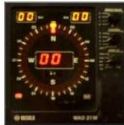
**Figura 1.7:** INDICADOR PARA SISTEMAS DE VIENTO.-
