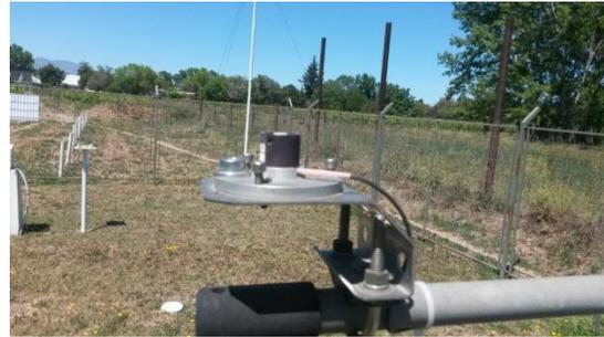
Foto 5: Sensor de Radiación Solar.-
