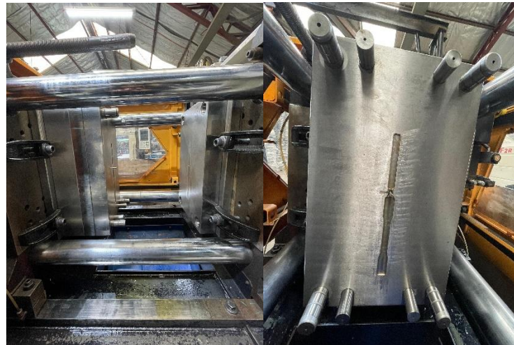
Figura 48: Molde de inyección para los ensayos mecánicos de tracción y flexión fabricado por Sistemold.
