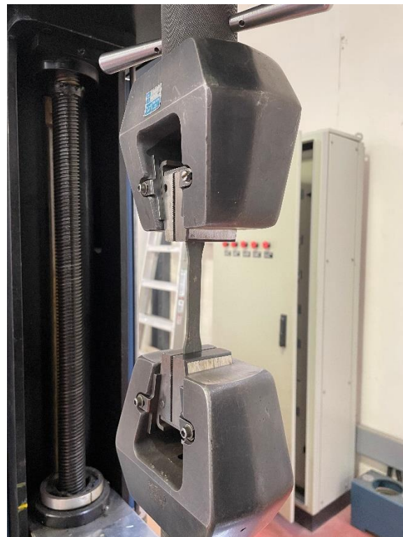
Figura 51: Cupón cargado en la máquina de medición.
