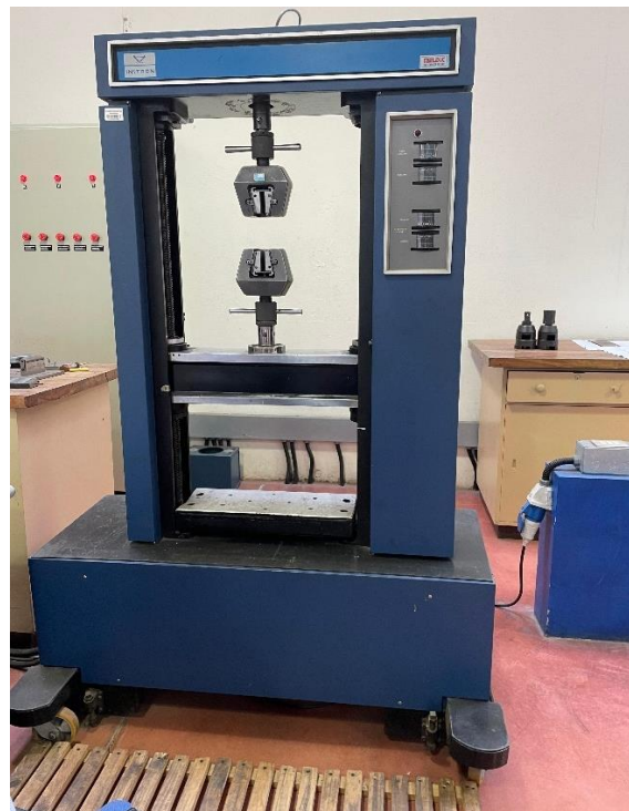
Figura 49: Máquina INSTRON TTDM10 perteneciente al laboratorio de mecánica de la UTFSM CC.
