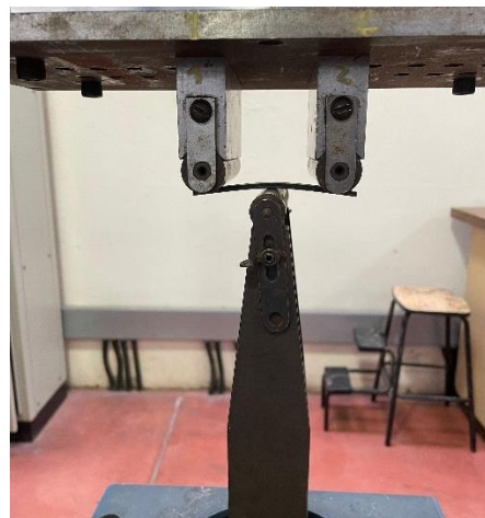
Figura 57: Cupón cargado en la máquina de medición.
