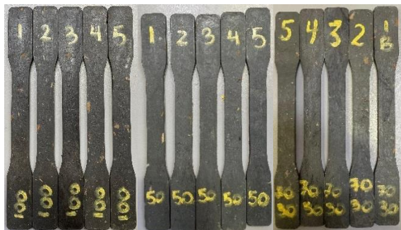
Figura 50: Probetas para el ensayo de tracción, de izquierda a derecha grupo de probetas al 100% de SCRAP, 70% de SCRAP y 50% de SCRAP.
