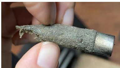
Figura 62: Material de SCRAP atascado en la boquilla de la máquina de medición.
