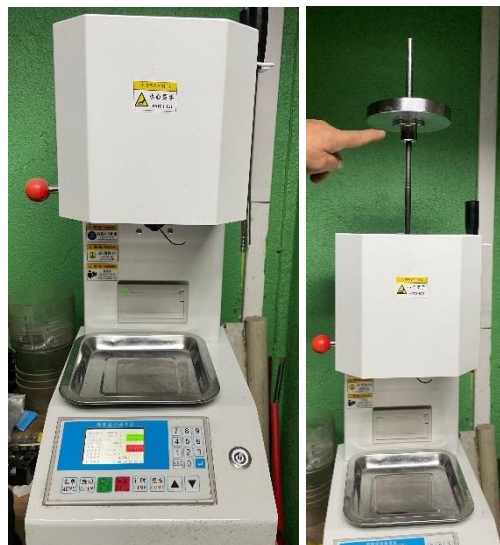
Figura 61: De izquierda a derecha: máquina de medición de fluidez, máquina de medición cargada con el peso mínimo.
