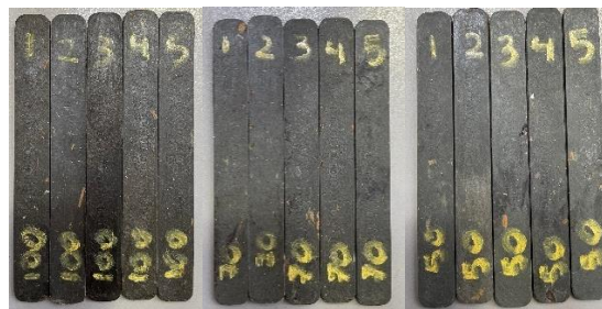
Figura 56: Probetas para el ensayo de flexión, de izquierda a derecha grupo de probetas al 100% de SCRAP, 70% de SCRAP y 50% de SCRAP.
