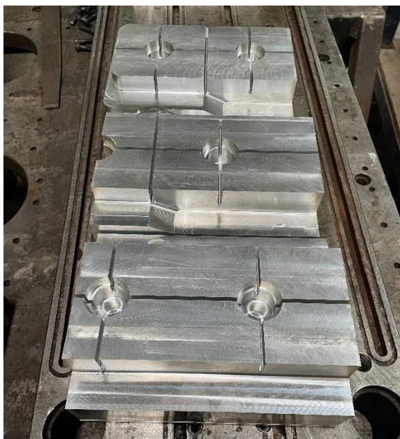
Figura 80: Postizos mecanizados para la tabla deck y patín.
