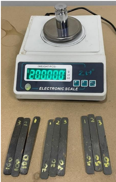
Figura 60: Pesa, probetas y peso de calibración.
