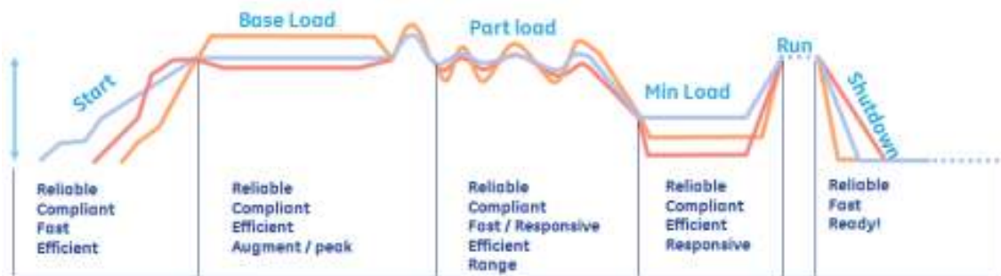
Figura 90. Características actuales de las centrales de generación térmica ante una operación cíclica. Fuente: Cost-Benefit Analysis of Flexibility Retrofits for Coal and Gas-Fueled Power Plants
