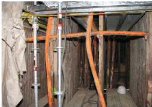
Figura 6 Daño tubos SH. arqueamiento severo y deformación térmica debido a sobrecalentamiento producto de un bajo o nulo flujo de vapor de agua de refrigeración durante cycling. Fuente: IMPACT OF PLANT CYCLING ON AVAILABILITY. POWER2015-49359
