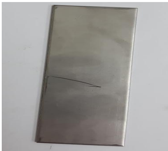
Figura 2-11: Cátodo de acero inoxidable (acero 316L)
