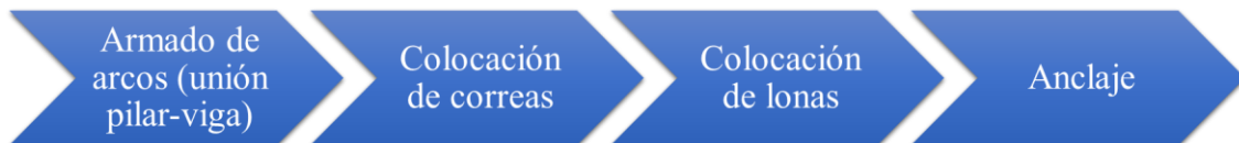
Figura 31: Proceso de montaje de carpa
