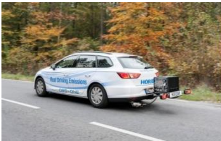
Figura 65: Automóvil realizando un ensayo RDE, mediante el uso de PEMS [12]
