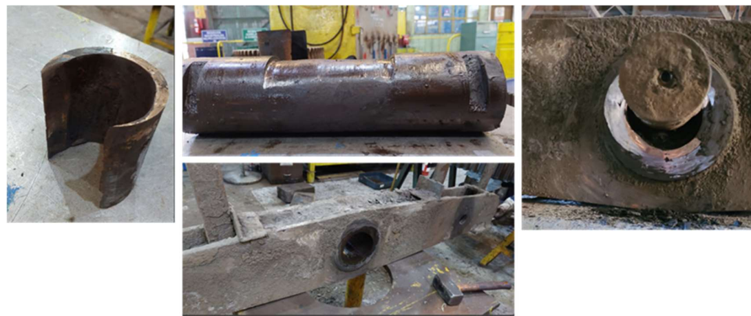
Figura 2- 14: Imágenes de la falla en balancin de compensación.
