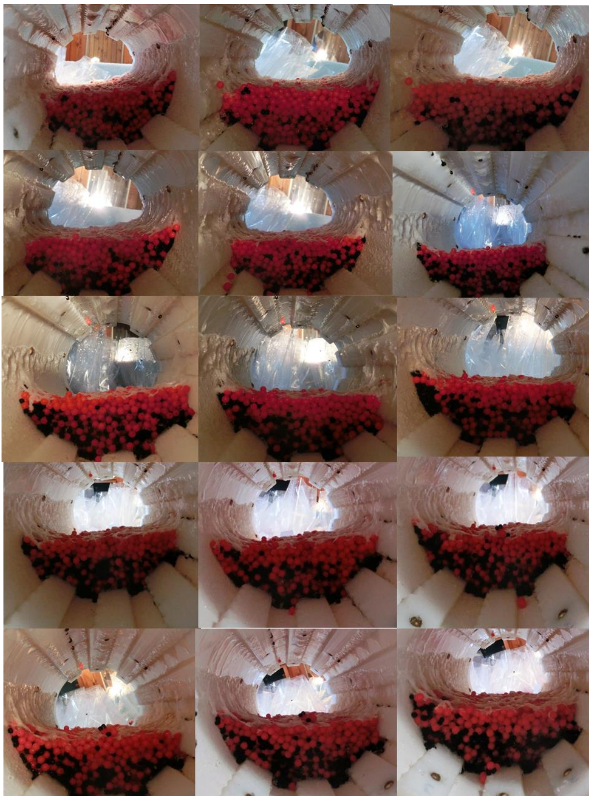
Figura 59 Experimento número uno (1) con el revestimiento 75/15 girando a un 75 % de la velocidad crítica. De izquierda a derecha y de arriba hacia abajo se observa Sección 17 a Sección 33
