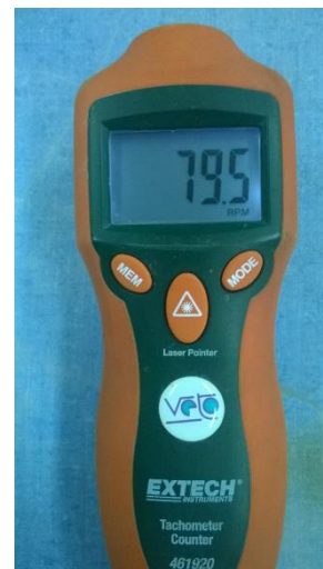
Figura 23 Tacómetro utilizado para verificar la velocidad de rotación del molino en RPM
