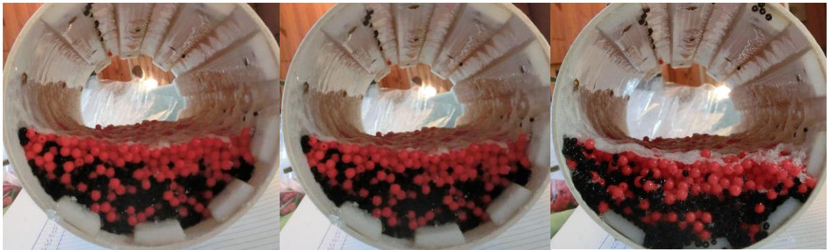
Figura 34 Experimento número dos (2) con el revestimiento 75/15 girando a un 75 % de la velocidad crítica. De izquierda a derecha se observa Sección 38 a Sección 40
