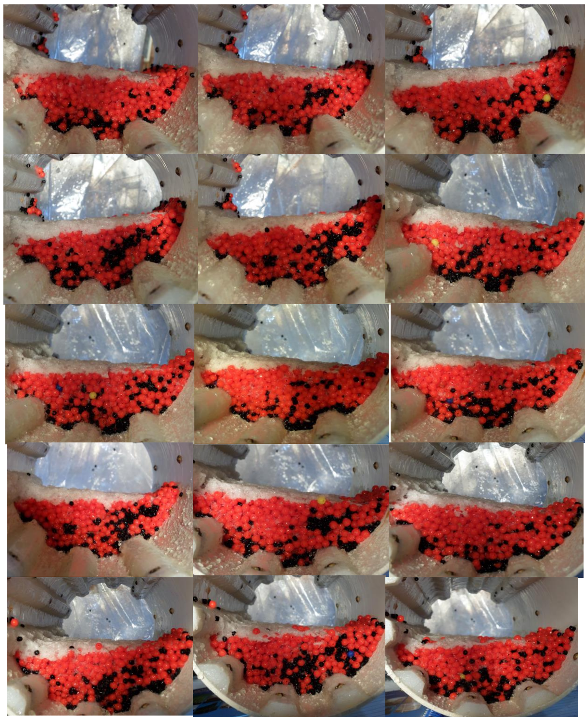
Figura 62 Experimento número dos (2) con el revestimiento 50/15 girando a un 50 % de la velocidad crítica. De izquierda a derecha y de arriba hacia abajo se observa Sección 17 a Sección 33
