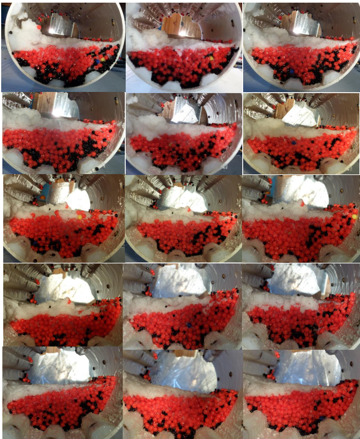
Figura 61 Experimento número dos (2) con el revestimiento 59/15 girando a un 50 % de la velocidad crítica. De izquierda a derecha y de arriba hacia abajo se observa Sección 1 a Sección 16
