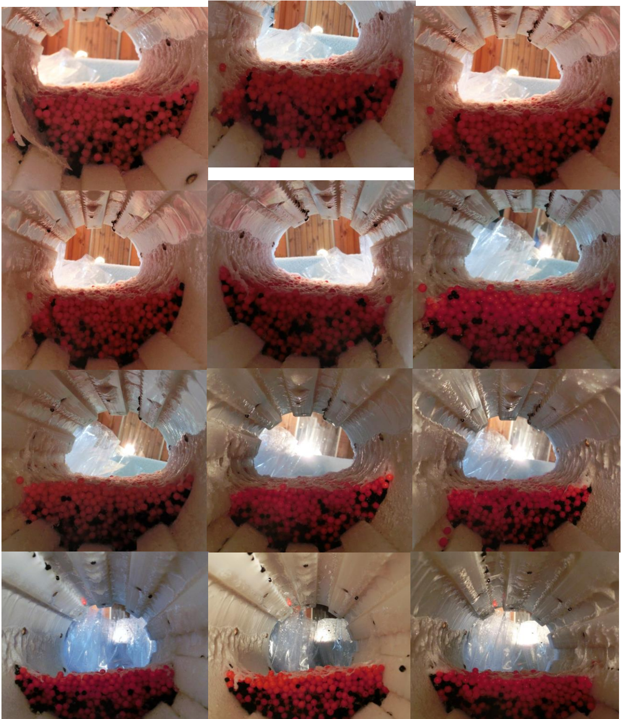
Figura 32 Experimento número dos (2) con el revestimiento 75/15 girando a un 75 % de la velocidad crítica. De arriba hacia abajo y de izquierda a derecha se observa Sección 13 a Sección 24
