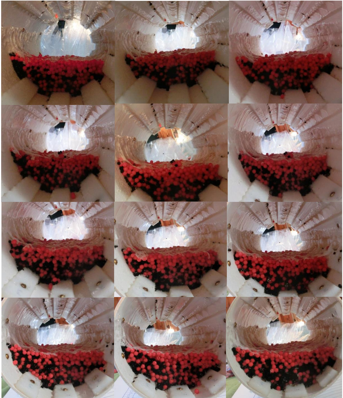
Figura 33 Experimento número dos (2) con el revestimiento 75/15 girando a un 75 % de la velocidad crítica. De arriba hacia abajo y de izquierda a derecha se observa Sección 25 a Sección 37
