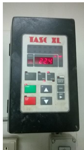
Figura 22 Regulador externo de velocidad de rotación de los rodillos
