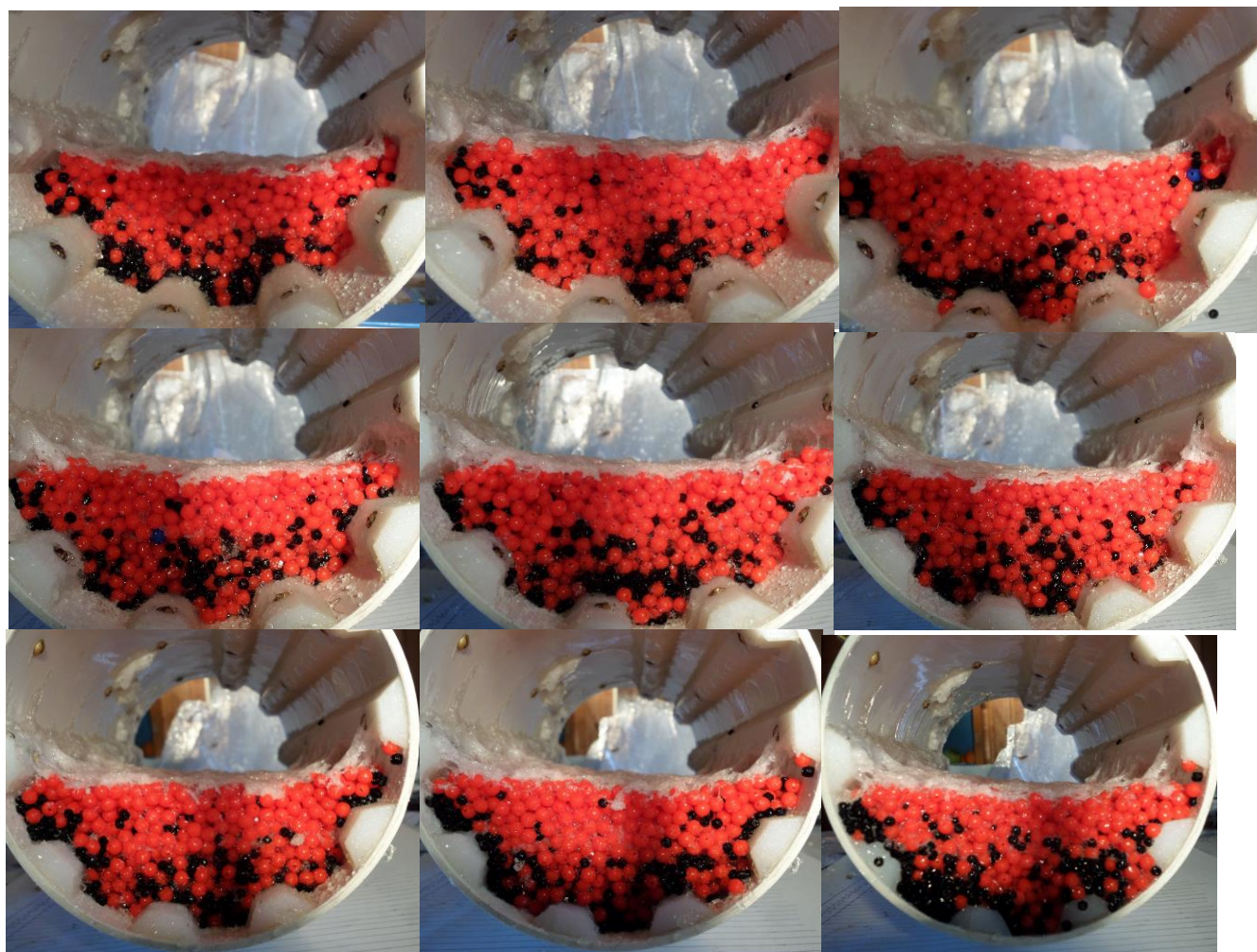
Figura 66 Experimento número dos (2) con el revestimiento 50/15 girando a un 75 % de la velocidad crítica. De izquierda a derecha y de arriba hacia abajo se observa Sección 32 a Sección 40
