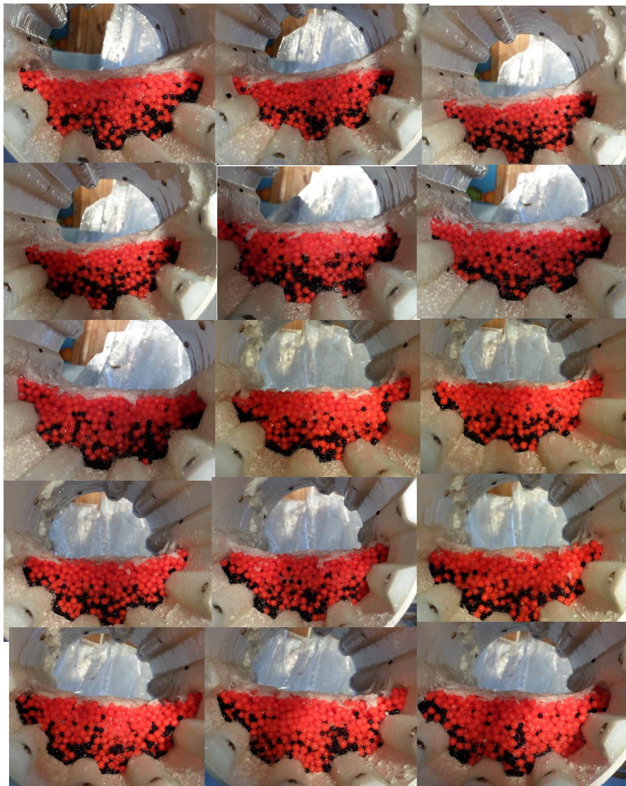
Figura 65 Experimento número dos (2) con el revestimiento 50/15 girando a un 75 % de la velocidad crítica. De izquierda a derecha y de arriba hacia abajo se observa Sección 16 a Sección 31
