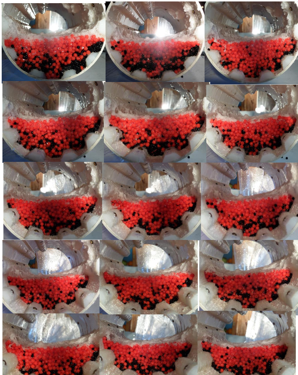
Figura 64 Experimento número dos (2) con el revestimiento 50/15 girando a un 75 % de la velocidad crítica. De izquierda a derecha y de arriba hacia abajo se observa Sección 1 a Sección 16
