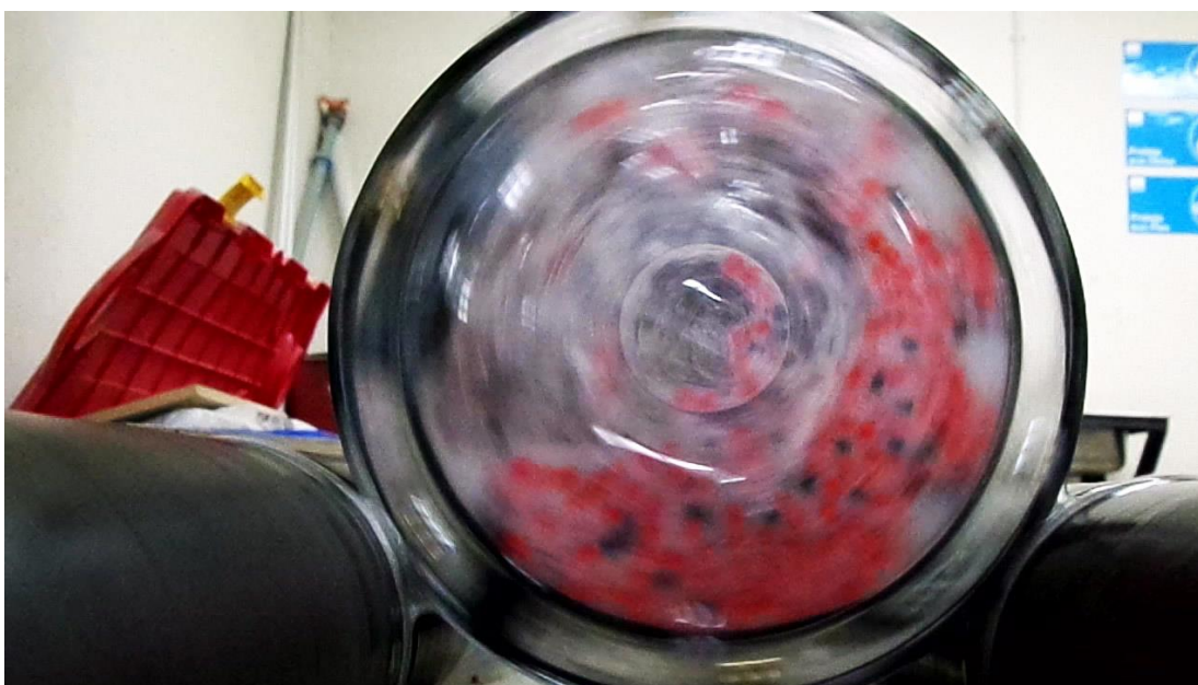
Figura 29 Fotograma obtenido a velocidad de rotación 50% V_c para levitador 1 (caso base)
