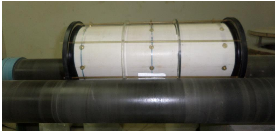
Figura 21 Molino montado sobre rodillos giratorios.
