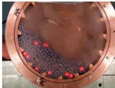
Figura 8 Segregación radial. Velocidad de rotación 25% de la velocidad crítica.
