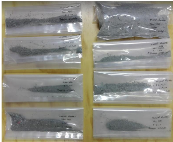
Figura. C. 19: Concentrado a distintos tiempos de flotación.
