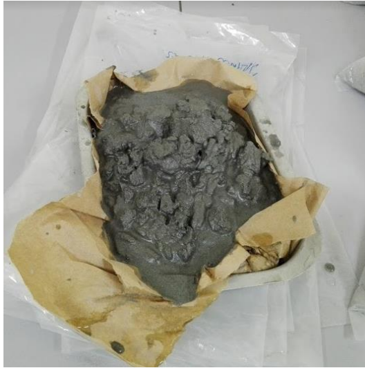
Figura. C. 5: Mineral deslamado bajo malla #325 Tyler.
