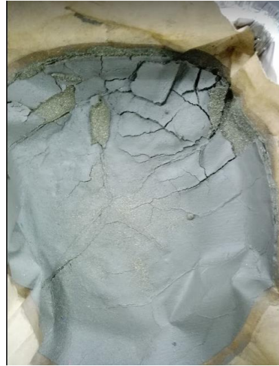
Figura. C. 18: Concentrado de flotación filtrado en prensa.
