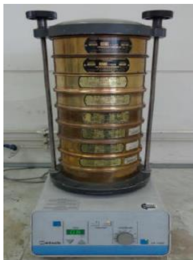
Figura. C. 11: Ro-Tap y set de mallas Tyler para análisis granulométrico.
