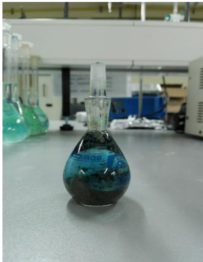
Figura. C. 7: Picnómetro para medir densidad de sólido mediante kerosene.
