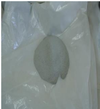
Figura. C. 3: Roleo de mineral previo a molienda.
