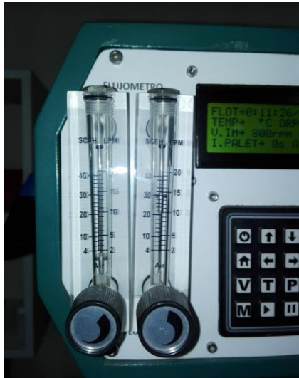
Figura. C. 13: Reguladores de flujo de aire de equipo de flotación EDEMET.
