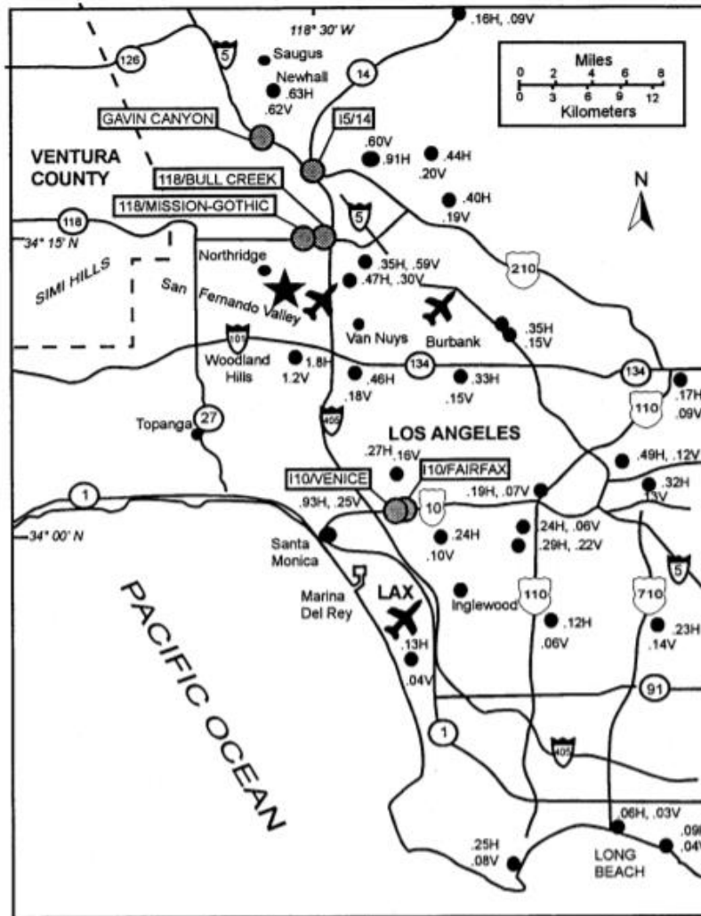
Figura 2.4 - Puentes Colapsados (círculos grises) durante el Terremoto de Northridge (1994). Fuente: [11].
