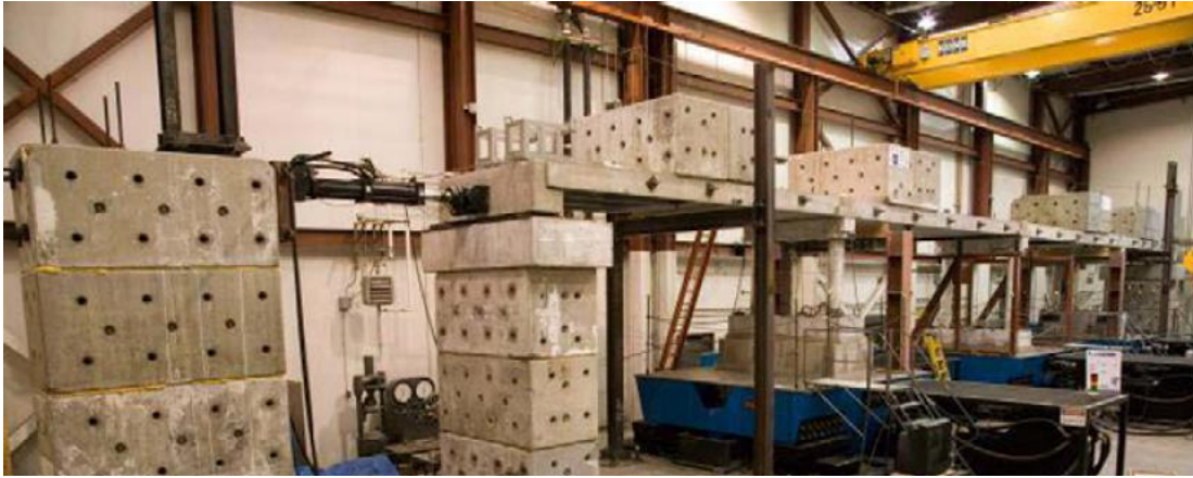
Figura 2.22 - Modelo a Escala 1:4 (Saiidi et al., 2013). Fuente: [21].
