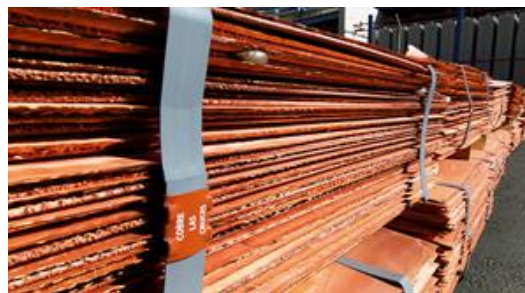
Fuente: Imagen obtenido de la página de Codelco. Figura 3: Cátodos de cobre obtenidas por los procesos de la División El Teniente, Machalí, Chile.
