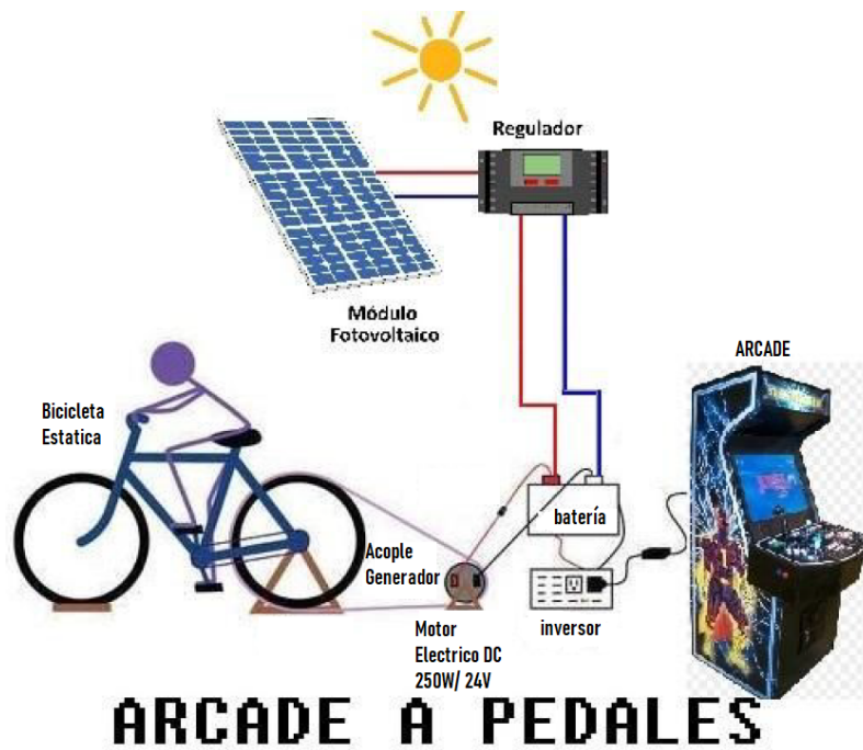
Figura 1-1. Esquema de funciones principales del sistema de entretenimiento propuesto "Arcade a pedales"
