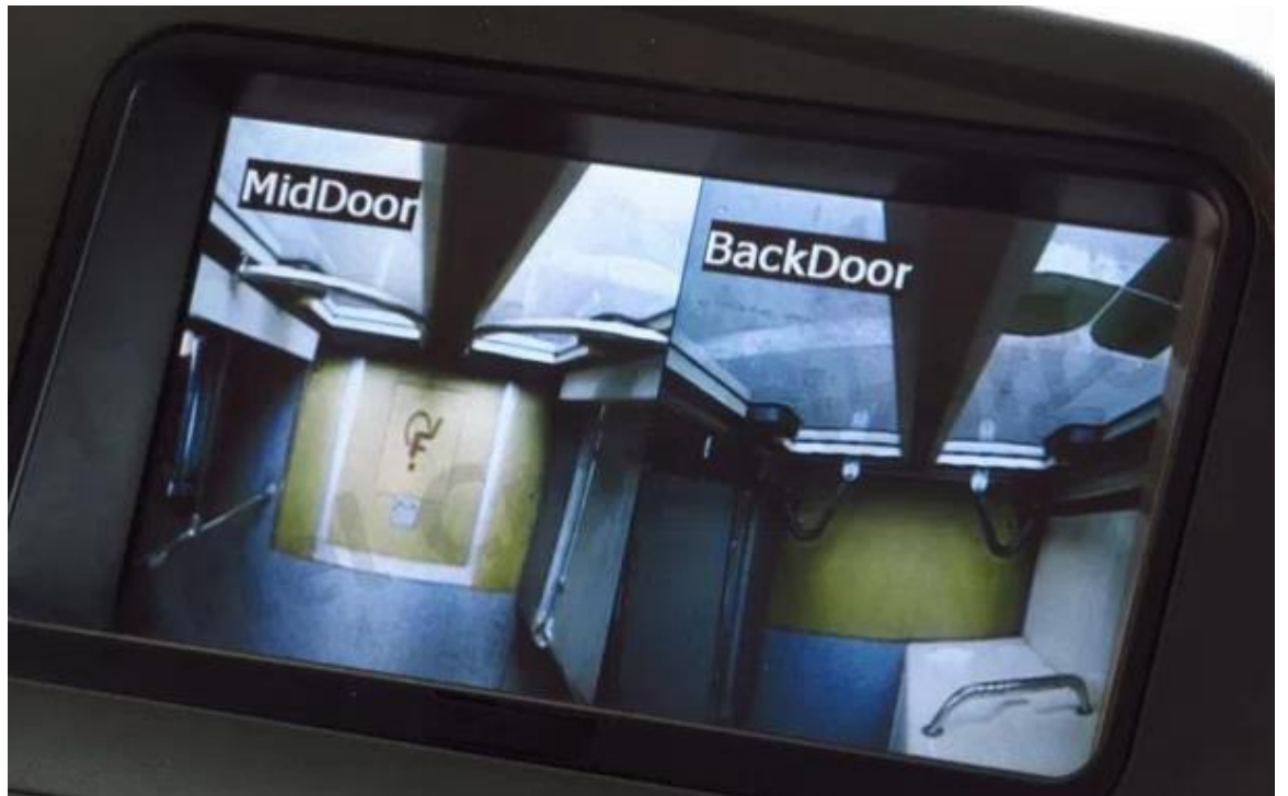
Figura 1-11. Disposición cámaras internas de puertas.
