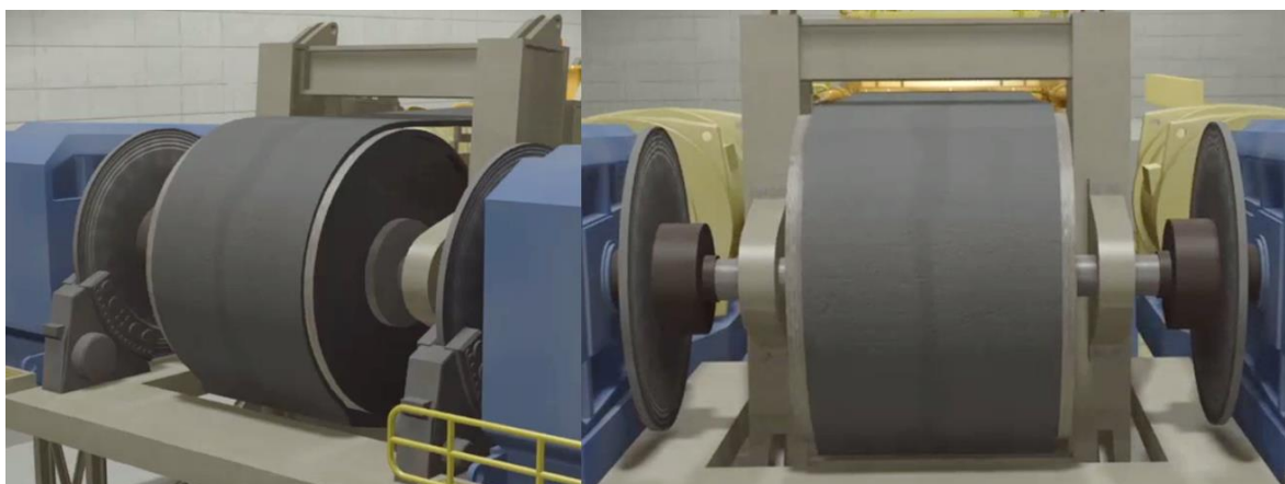
Ilustración 37: Retiro freno Caliper polea n°1
