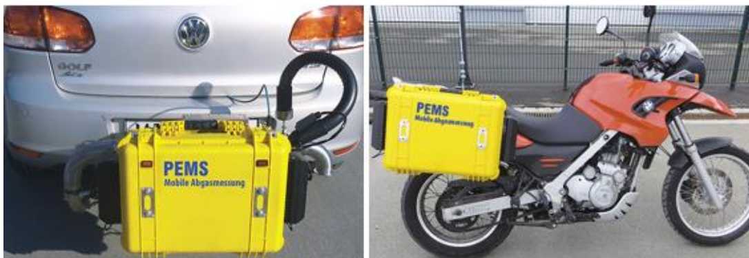
Figura 9: Muestreo de partículas en vehículos llevado a cabo con PEMS.[15]
