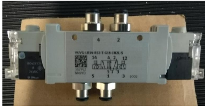
Figura 28: Electroválvula Festo 5/2 utilizada para mover actuador neumático.
