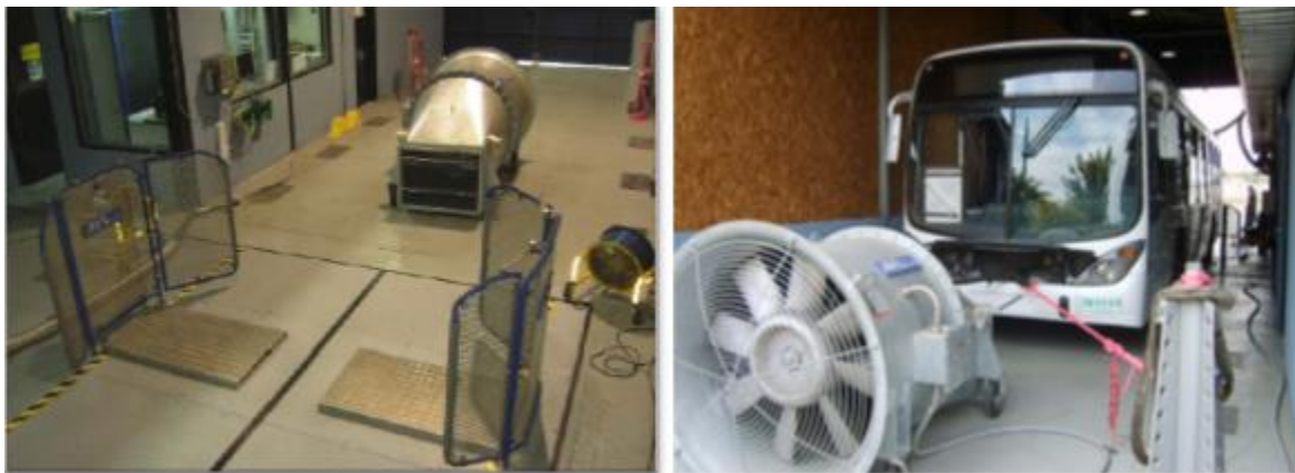
Figura 6: Dinamómetro de chasis (izq.). Autobús del Transantiago siendo testeado en el dinamómetro (der.).
