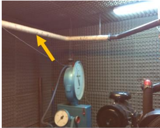
Figura 45: Sección del tubo de escape (flecha) donde entra la sonda Termoforética, notar que el punto de muestreo está en altura respecto al suelo del laboratorio.
