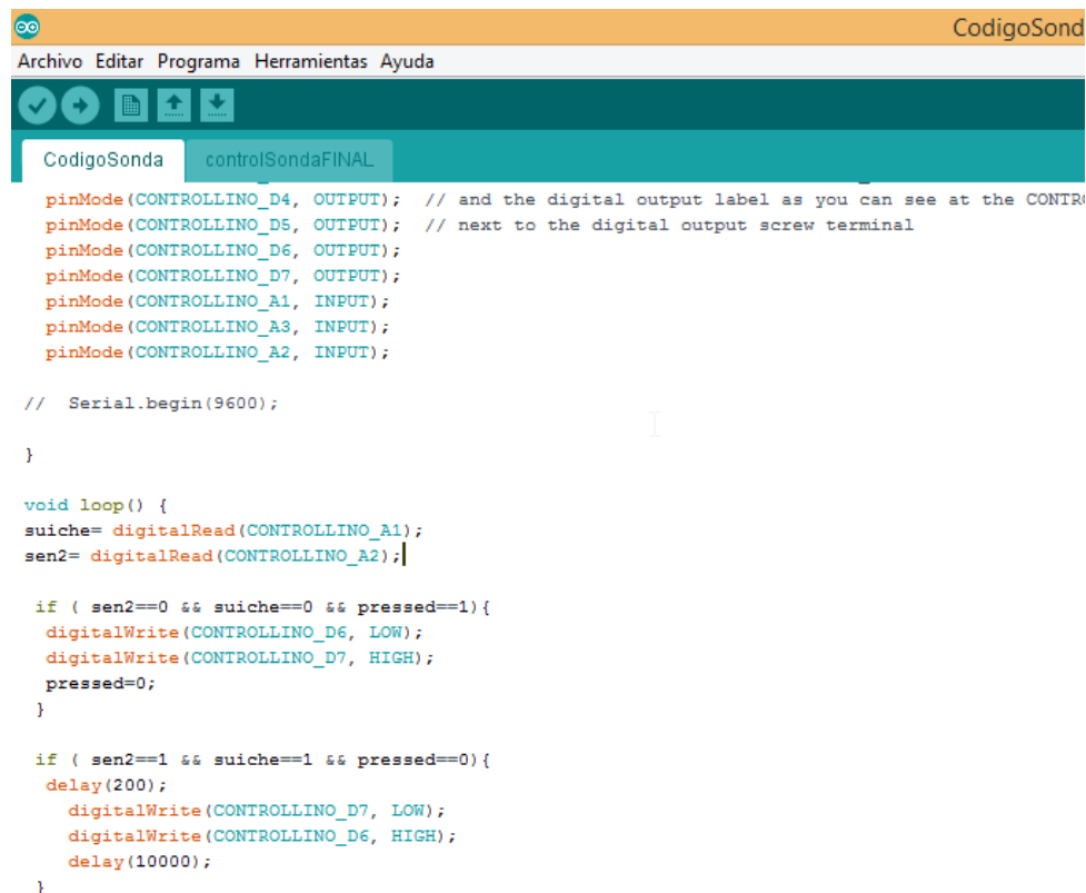
Figura 20: Arduino IDE para programar el código del control de la sonda termoforética.
