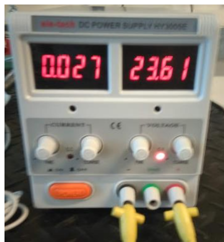
Figura 46: Fuente de poder variable que permite determinar la corriente que utiliza el circuito del sistema de muestreo. Notar los valores de la corriente y el voltaje, respectivamente.
