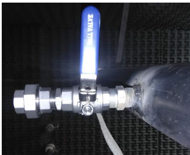
Figura 41: Unión americana conectada a la válvula de bola unida al conector soldado al tubo de escape, todos estos componen el sistema de entrada de la sonda Termoforética.
