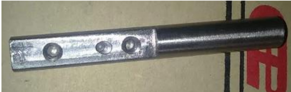
Figura 43: Porta filtro construido con acero inoxidable.
