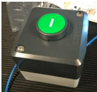
Figura 29: Pulsador eléctrico que da inicio a la entrada de la sonda al tubo de escape.
