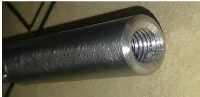
Figura 44: Rosca hembra M6 x 1.0 del porta filtro para conectarse al vástago del cilindro neumático.
