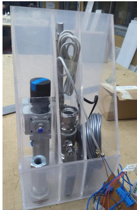
Figura 47: Vista frontal de la parte inferior de la caja contenedora durante su construcción con cada elemento en su cavidad respectivamente.
