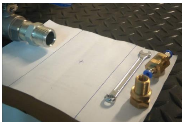
Figura 51: Prueba de tiempo de exposición del filtro, notar que en el perímetro que representa el tubo de escape tiene marcado el centro geométrico donde debe posicionarse el filtro.
