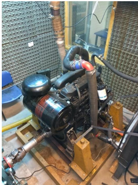
Figura 15: Dinamómetro de motor Diésel dentro de la sala acondicionada para el funcionamiento del MCI.
