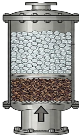
Figura 4.1: Esquema transversal de la celda de extracción, detallando la ubicación del lecho de semilla y el relleno distribuidor de perlas de vidrio.
