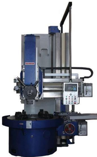
Figura 1-5. Torno vertical Fuente: Página web empresa Famasa
