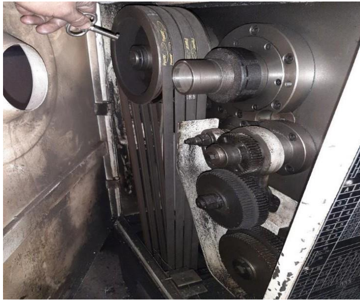
Figura 1-11. Engranajes internos del torno
