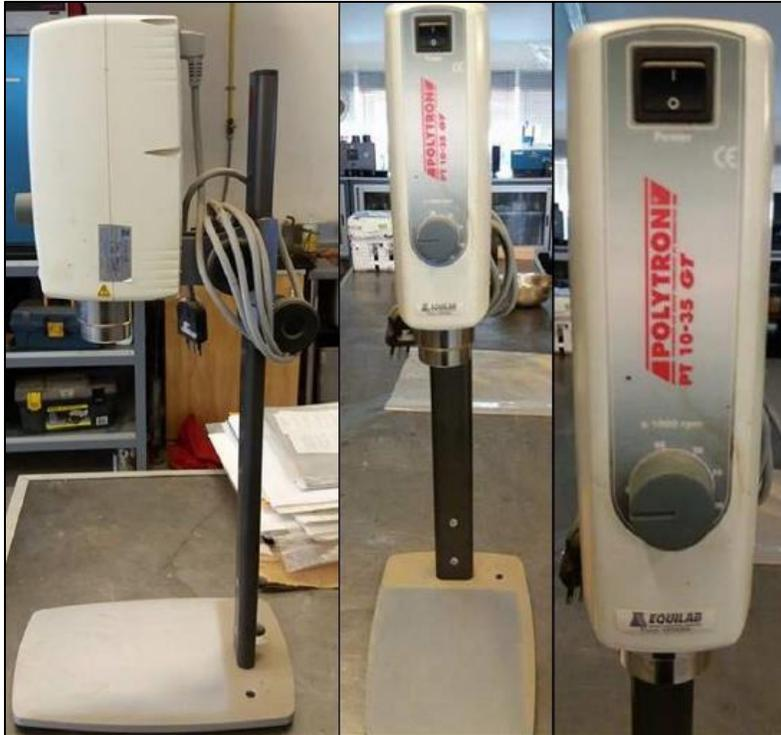
Figura 59. Mezclador de alto corte POLYTRON PT 10-35 GT. Fuente: elaboración propia.
