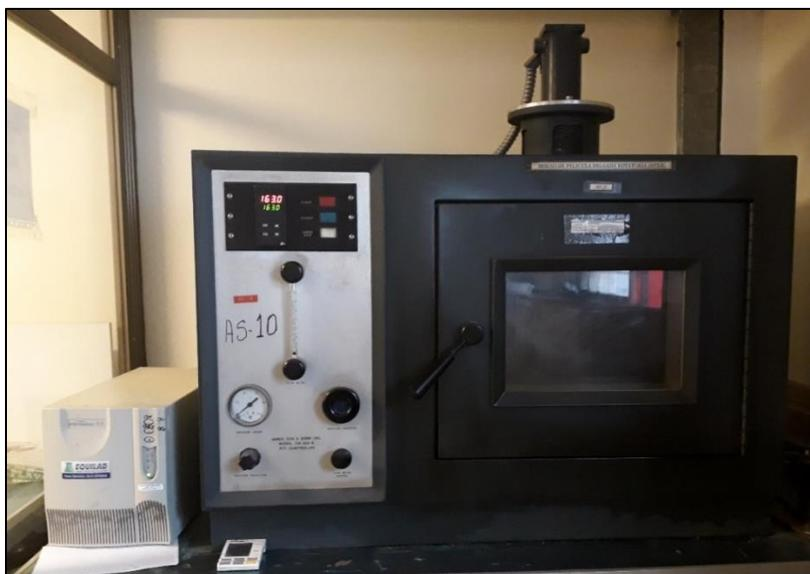
Figura 62. Horno de Película Delgada Rotatoria Modelo CS 325-B. Fuente: elaboración propia.
