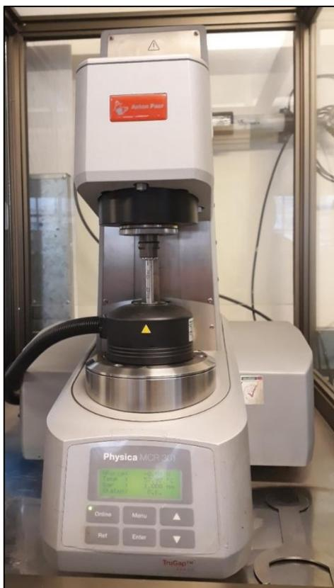
Figura 66. DSR Anton Paar PHYSICA MCR 301. Fuente: elaboración propia.
