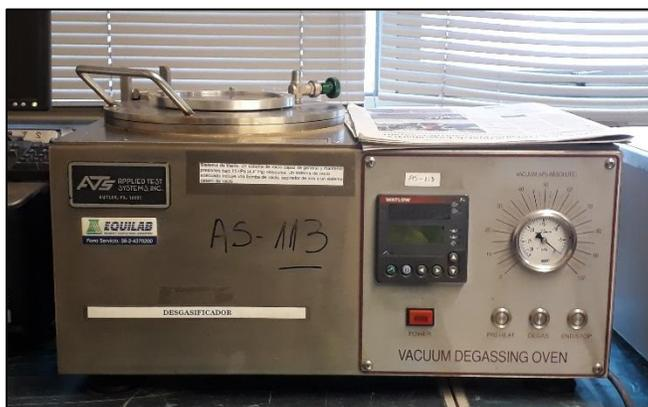
Figura 64. Cámara de vacío. Fuente: elaboración propia.
