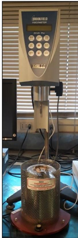
Figura 65. Viscosímetro Brookfield DV-II+ pro. Fuente: elaboración propia.
