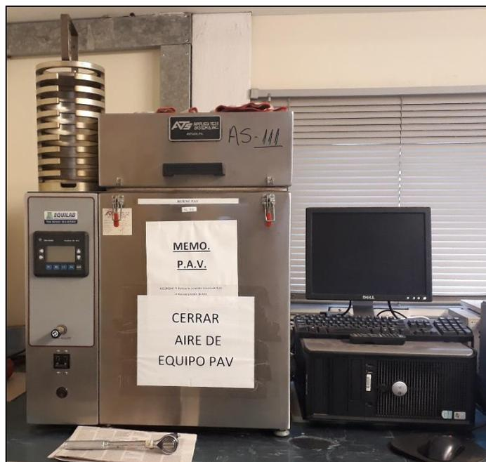
Figura 63. Cámara de Envejecimiento a Presión ATS. Fuente: elaboración propia.
