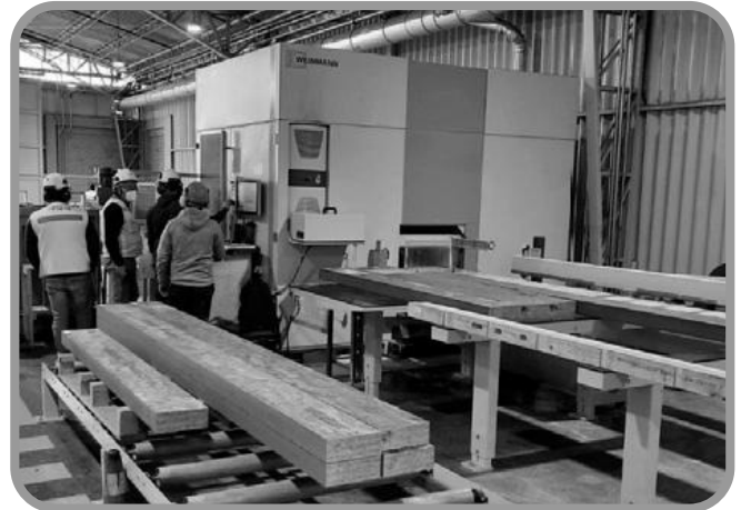
Procesadora de vigas
