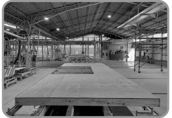
Panel de entrepiso finalizado
