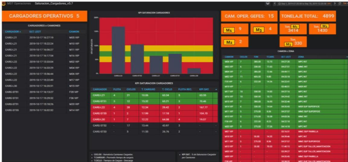
Fig. 8 Ejemplo de Panel de Predicción de Ocupación de Cargadores en base a Big Data- Fuente: MST Global
