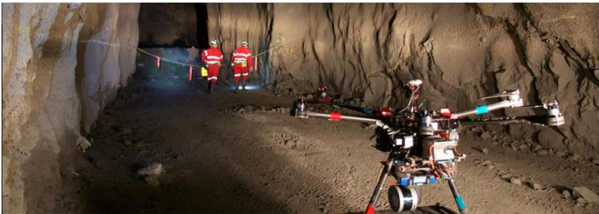
*Fig. 10 Dron en Interior Mina realizando labores de mapeo geológico - Fuente: <https://www.miningmagazine.com/>*
