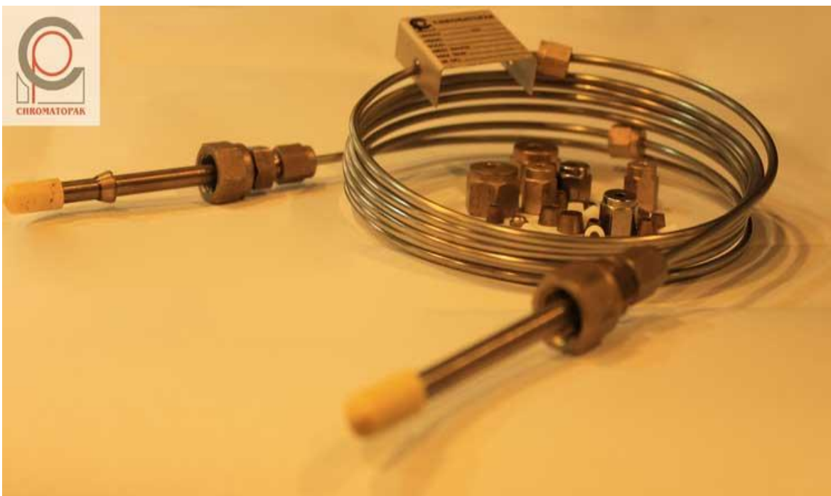
Imagen columna cromatográfica empacada acero inox. Fuente www.chromatopack.com
