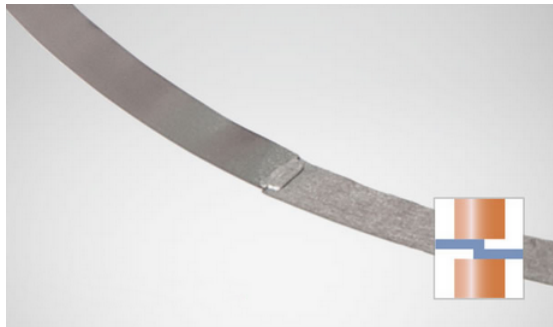
Figura E.5: Soldadura solapada [100].
