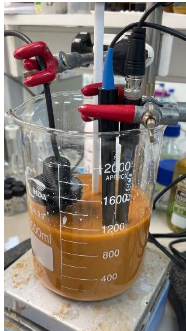
Figura 21. Neutralización por medio de probeta al inicio a 1 L de la solución 2
