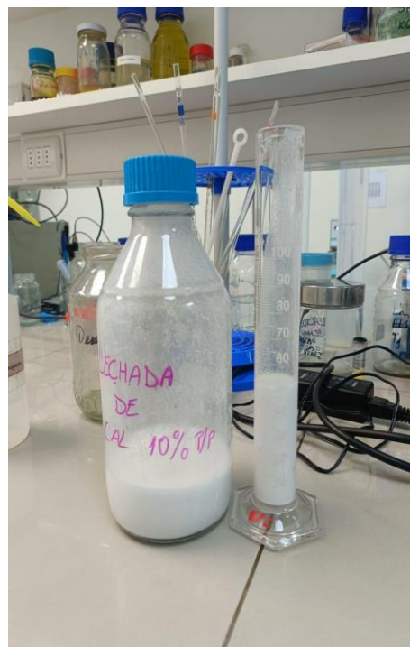
Figura 16. Probeta de dosificación y recipiente para \text{Ca}(\text{OH})_2
