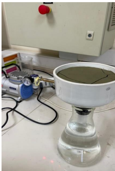
Figura 26. Filtración de solución 1 mediante bomba de vacío
