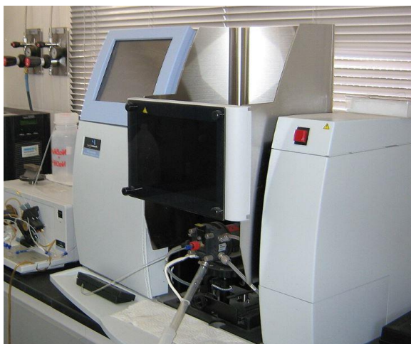
Figura 30. Espectrofotómetro de absorción atómica
