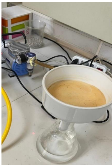
Figura 27. Filtración de solución 2 mediante bomba de vacío
