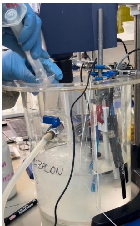
Figura 23. Neutralización 5 litros de solución 1
