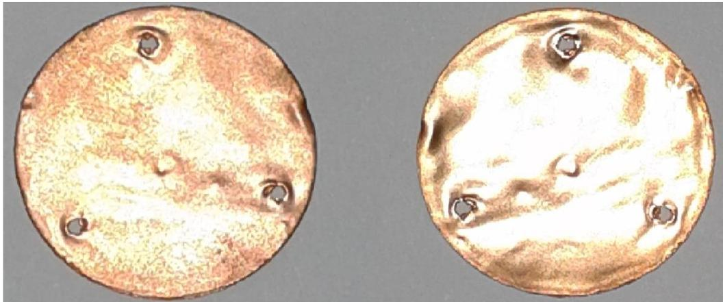
Figura 5.6.1. Fotografía de unas de las láminas de cobre de izquierda a derecha cara exterior e interior, posterior a la síntesis por AP-CVD de substrato doble.
