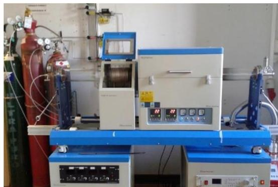
Figura 1.4.1. Horno CVD del grupo de física del sólido del departamento de física de la Universidad Técnica Federico Santa María.
