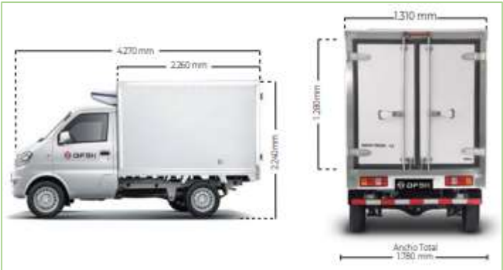
Figura 3–8. Dimensiones mini camioneta C21, marca DFSK
