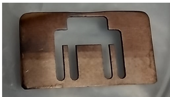
FIGURA 3.2: Máscara que asemeja al circuito del metodo de Kelvin
