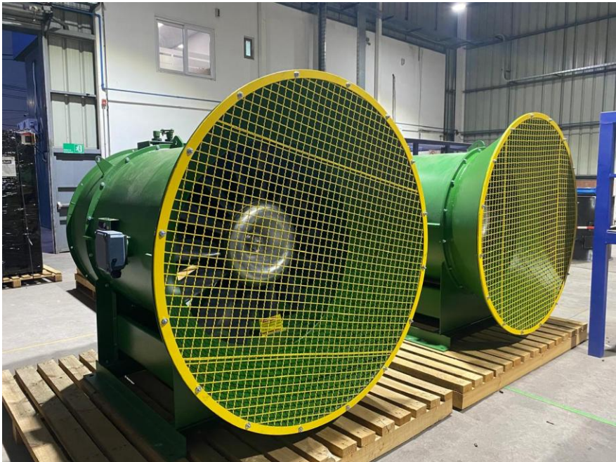
Figura 1.3 - 02 Ventiladores Axiales Howden de Alta eficiencia
