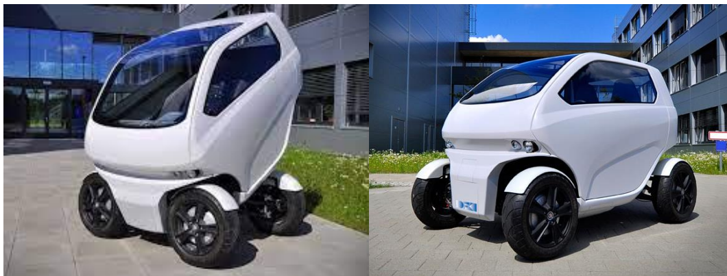
Figura 1-19. EO Smart Connecting Car 2 preparado para movimiento lateral, modo normal.
