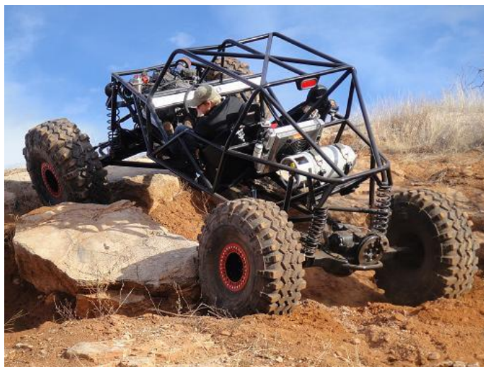
Figura 1-13. Ejemplo de Chasis tubular.
