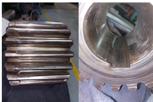
Figura 3 - 6. Desgaste de piñón.
