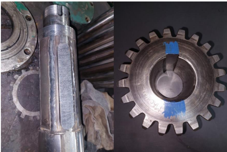
Figura 1- 19. Reparaciones de eje y piñón.
