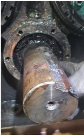
Figura 1- 15. Falla de rodamiento Enderezadora Aza.
