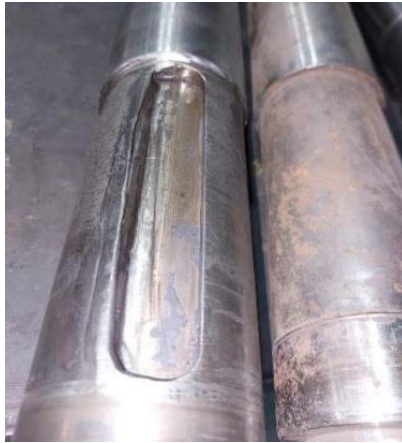
Figura 3 - 9. Falla en el chavetero del eje.
