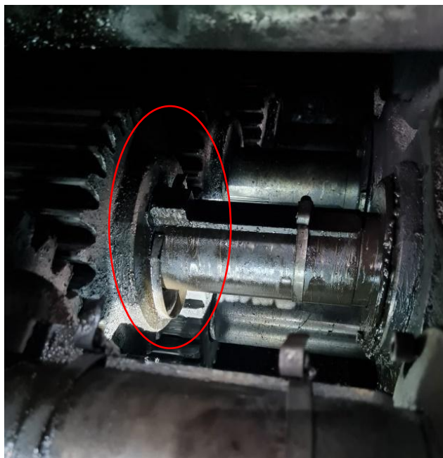
Figura 3 - 11. Chavetas aseguradas mediante abrazaderas.
