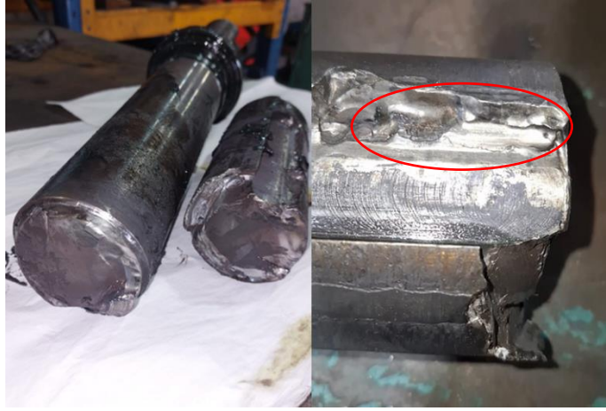
Figura 1- 20. Eje motriz fracturado.
