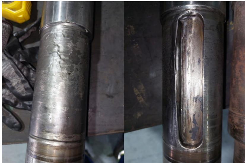
Figura 1- 17. Desgaste del eje motriz.
