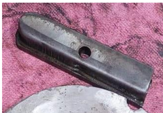
Figura 3 - 10. Falla de la chaveta.
