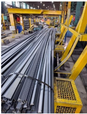
Figura 1- 7. Ángulos estructurales pre-enderezado.
