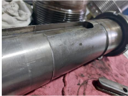
Figura 3 - 7. Desgaste de eje en diámetro del alojamiento.
