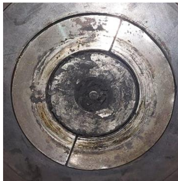
Figura 3 - 2. Presencia de laminilla metálica en grasera de rodillo enderezador.
