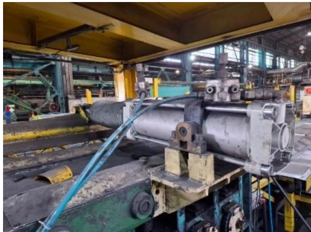
Figura 2 - 5. Cilindro neumático alza tapa de protección.
