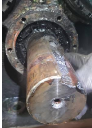
Figura 3 - 5. Falla de rodamiento por lubricación y contaminantes.
