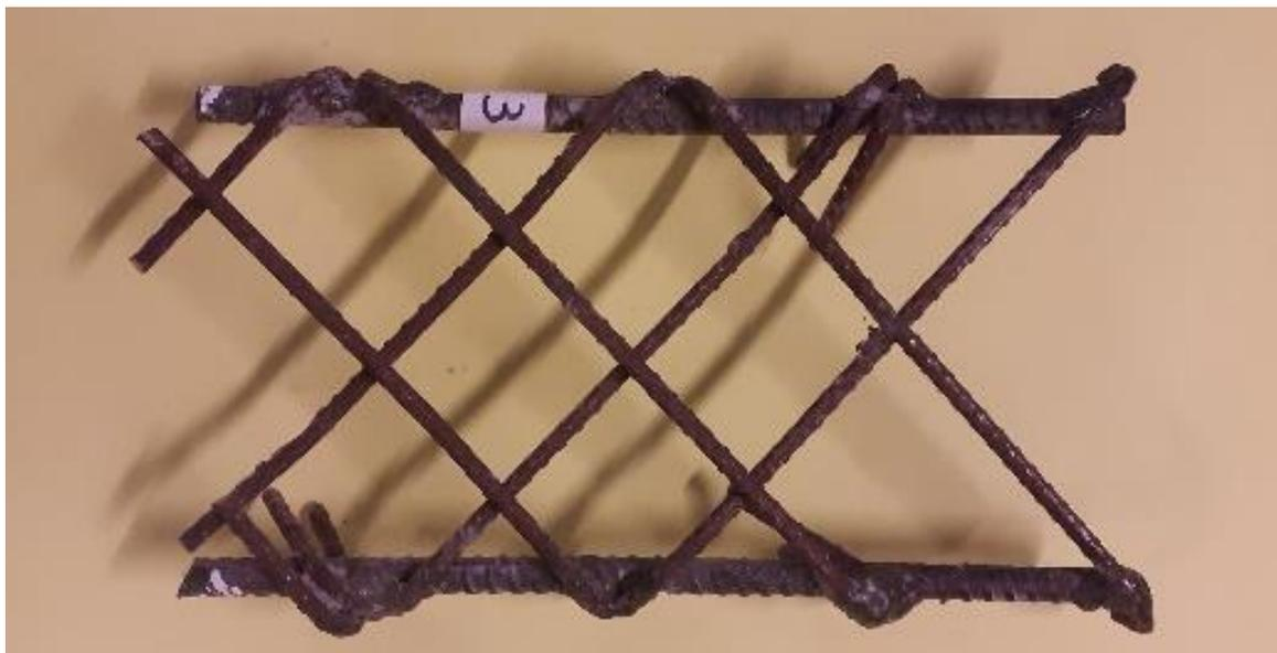
*Figura 3.5* Barras obtenidas de la probeta GF1
