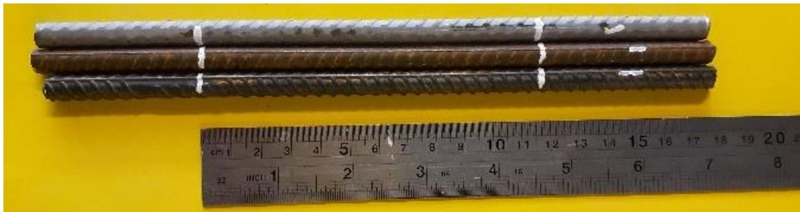
*Figura 3.2* Barras seleccionadas ACMA, CAP y AZA, ordenadas respectivamente de arriba a abajo
