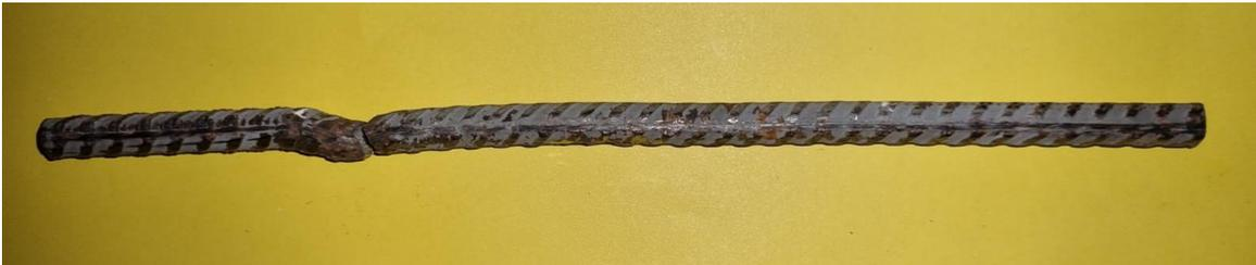
*Figura 4.7 Pandeo en la zona de la mordaza inferior en un ensayo con amplitud de deformación del 2% utilizando la camisa de acero*
