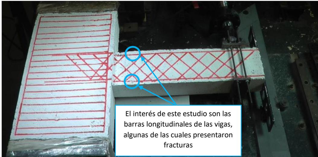
*Figura 1.2 Probeta sometida a ensayo de carga cíclica, F. Basualdo (2019)*
