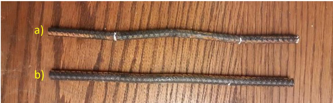
*Figura 4.6 Comparación entre barra ensayada a) con pandeo y b) sin pandeo*
