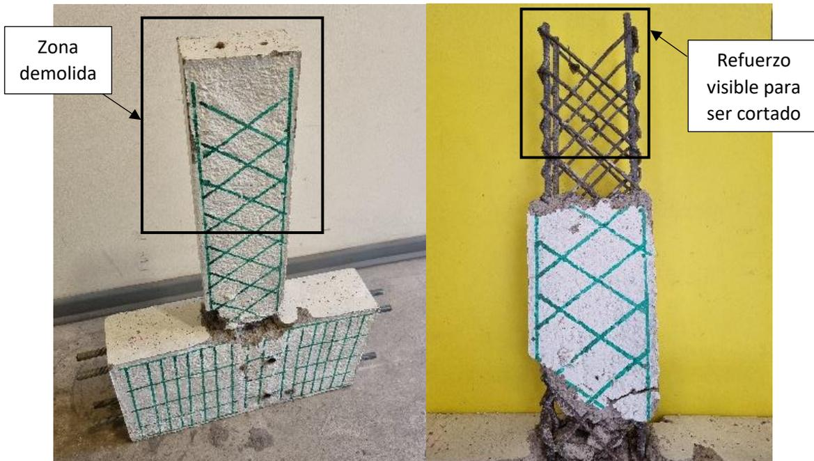
*Figura 3.4* Probeta P4 después de ser ensayada (foto a la izquierda) y después de ser retirado el hormigón del extremo dejando a la vista el refuerzo (foto a la derecha)
