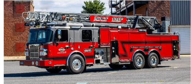
Imagen 22 Camión Spartan con estructura para escala mecánica (Spartan ER, 2023)
