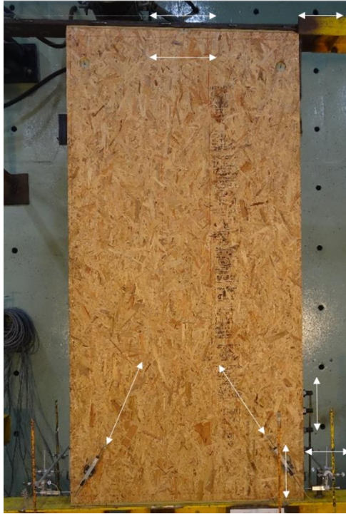
Figura 3-19, Fotografía de un muro a ensayar con los transductores instalados, para medir los desplazamientos
