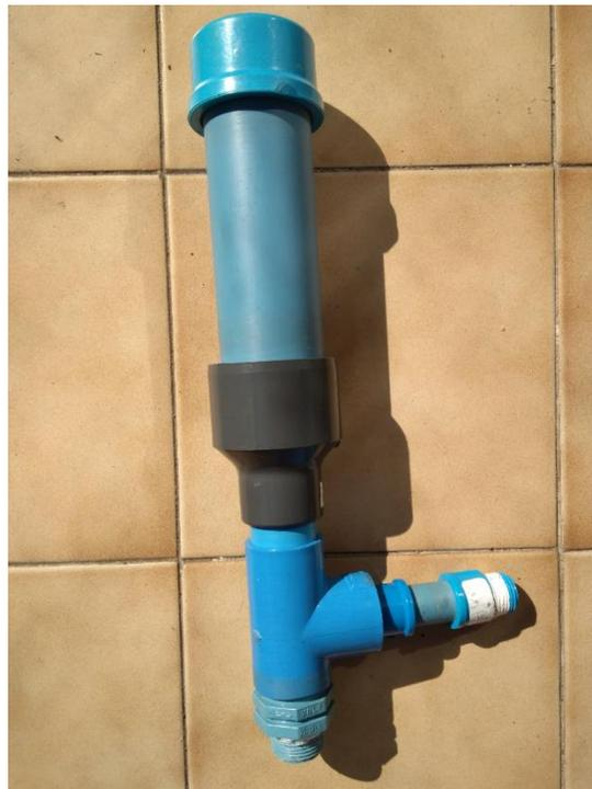
*Figura 6.9 Componente cámara de aire ariete marino*
