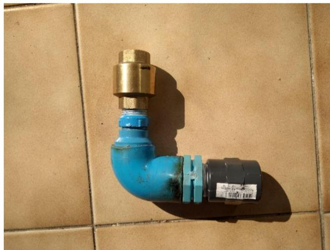
*Figura 6.10 Componente válvula de choque ariete marino*
